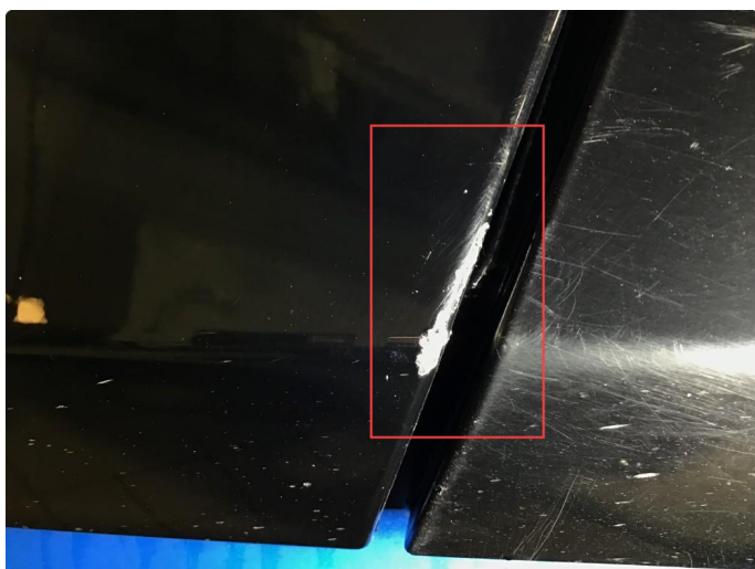
1.2 Noe riper / sår bakre del v-framdør ( Poleres / Flekkes )
