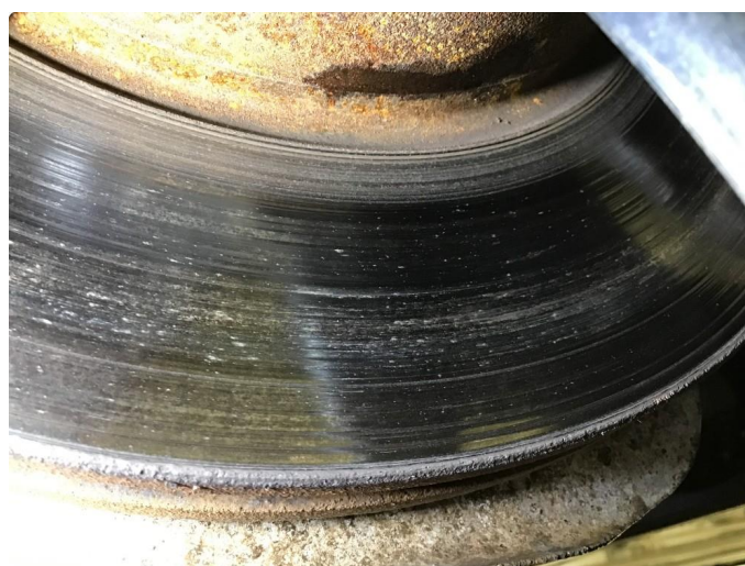
3.1 Noe slitasje bremseskiver fram , bremseklosser målt til 5,5 mm ( Normal bruksslitasje )
