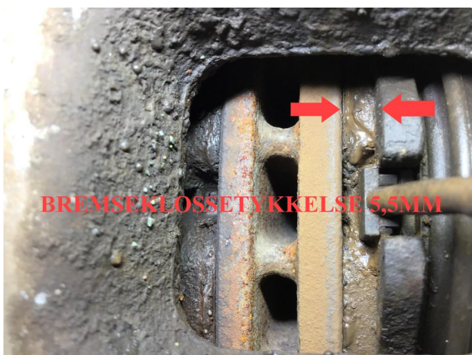
3.1 Noe slitasje bremseskiver fram , bremseklosser målt til 5,5 mm ( Normal bruksslitasje )
