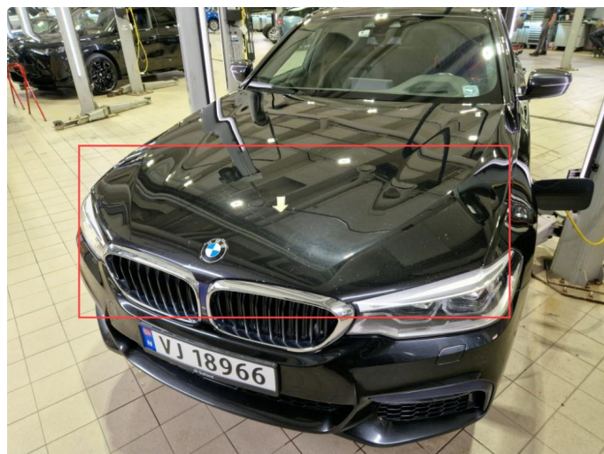
1.1 En del steinsprut på panser, normal bruksslitasje ihht alder og kilometerstand.
