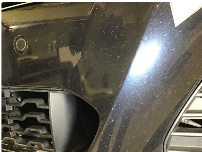
1.4 Noe slitasje i lakken på frontfanger.
