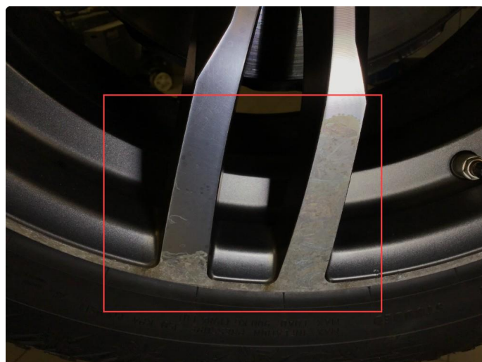
1.1 Noe korrosjon på vinterfelger.
