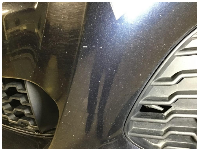
1.4 Noe slitasje i lakken på frontfanger.
