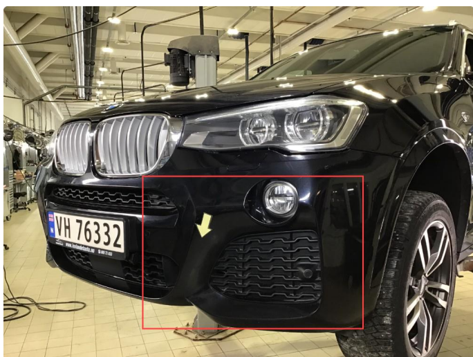
1.4 Noe slitasje i lakken på frontfanger.
