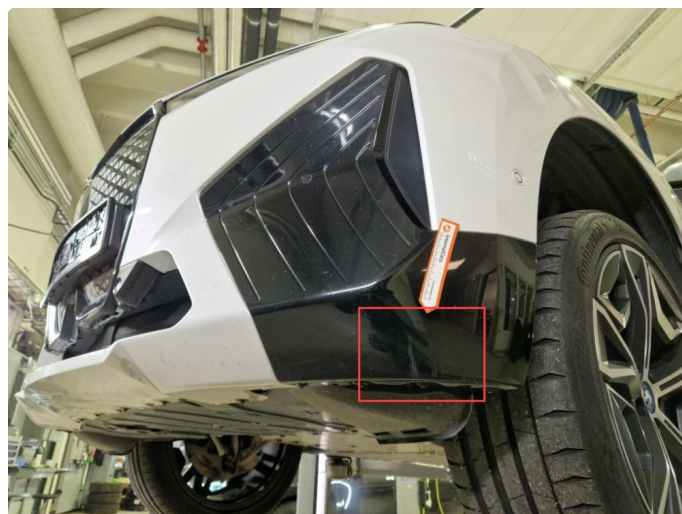
1.7 Noe skrubbermerker underkant fremfanger, normal bruksslitasje.
