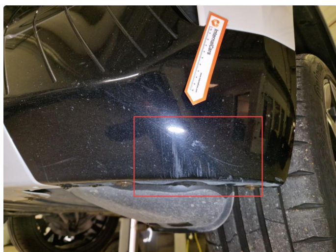
1.7 Noe skrubbermerker underkant fremfanger, normal bruksslitasje.
