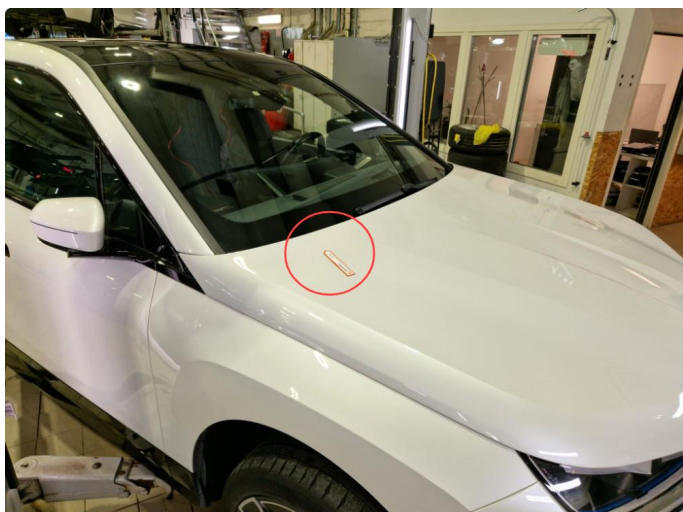
1.1 2 Stk små bulker øvre del h-side panser, normal bruksslitasje.
