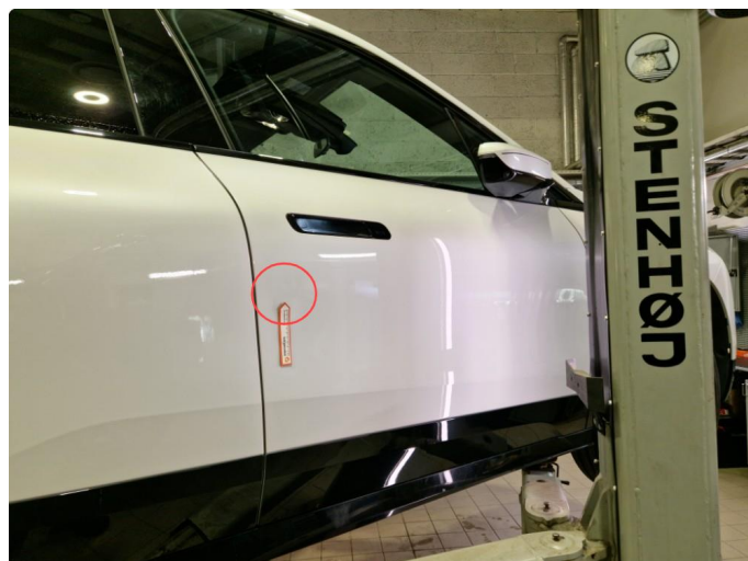
1.2 Liten p-bulk h-framdør, normal bruksslitasje.
