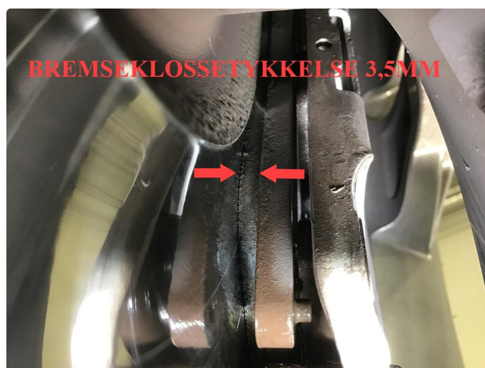
5.1 Slitte bremseskiver fram , målt til 3,5mm. Bremseskiver er glassert og har noe større slitekant.
