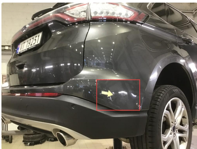
1.7 Dype riper nedre plastikk v-side bakfanger + noe riper h-side
