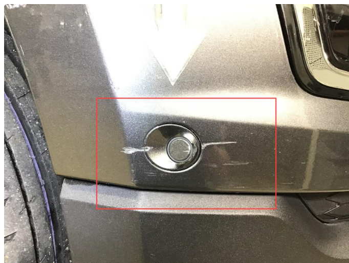
1.6 Noe lakksår nedre del h-side frontfanger.
