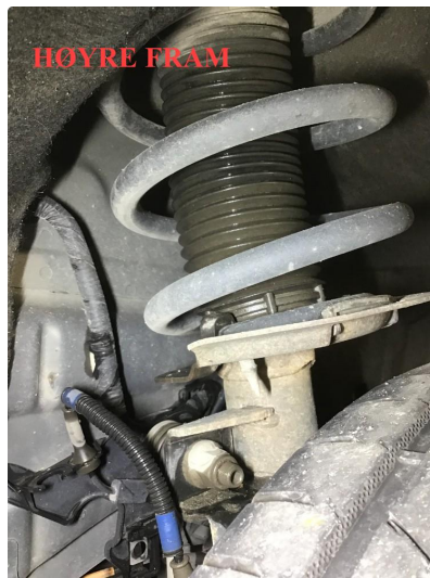
4.1 Lekkasje støtdemper v-ram.
