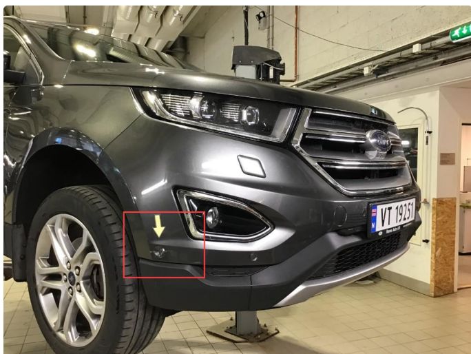
1.6 Noe lakksår nedre del h-side frontfanger.
