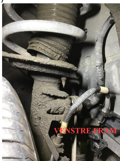
4.1 Lekkasje støtdemper v-ram.
