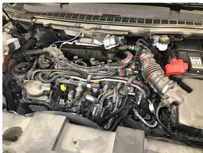
3.1 Oljelekkasje fra motor , mellom motor og høytrykkspumpe/ dieselpumpe ( Rep / demonteres pumpe og bytte pakninger / simring ?)
