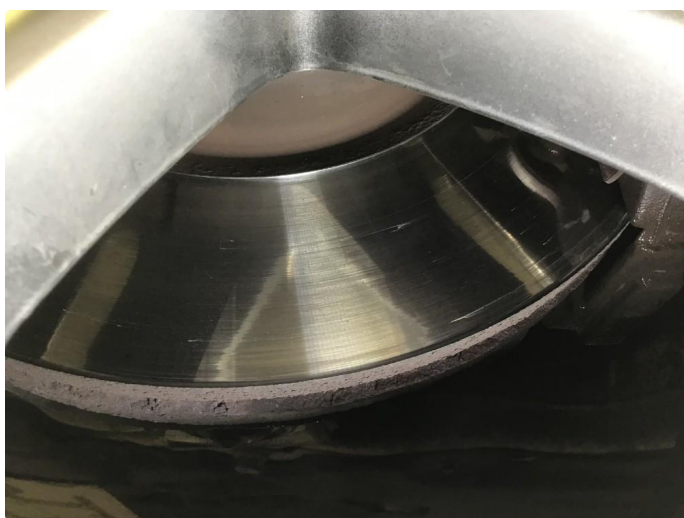
5.1 Slitte bremseskiver fram , målt til 3,5mm. Bremseskiver er glassert og har noe større slitekant.
