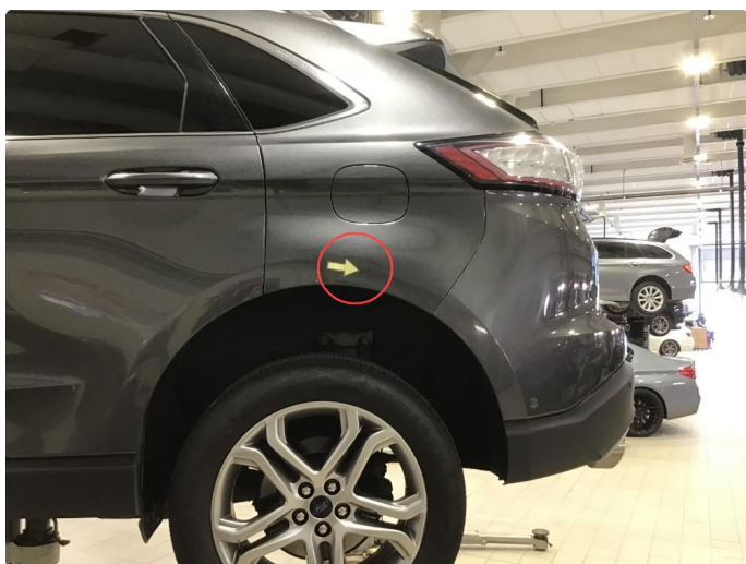
1.3 Liten p-bulk v-bakskjerm ( Normal bruksslitasje )
