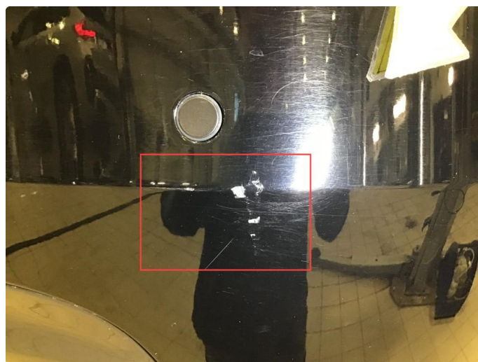
1.6 Noe riper / sår h-side bakfanger ( Poleres / Flekkes )
