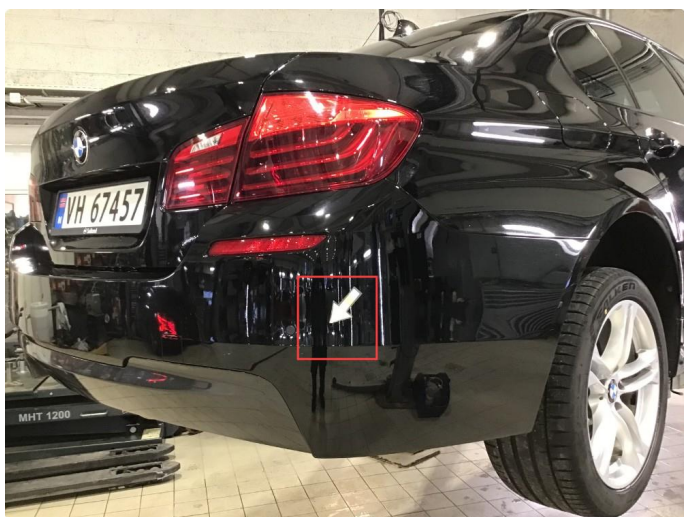
1.6 Noe riper / sår h-side bakfanger ( Poleres / Flekkes )
