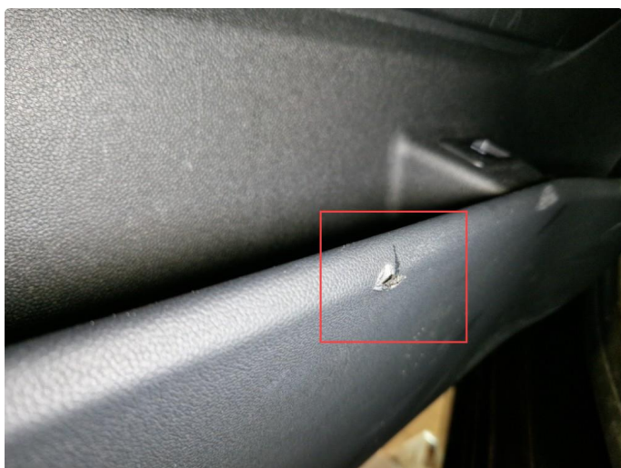
3.1 1 Stk lite rift nedre del dørtrekk v-framdør.
