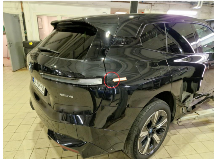
1.2 Liten p-bulk h-bakskjerm, normal bruksslitasje.
