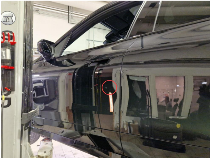
1.1 1 Stk liten p-bulk v-framdør, normal bruksslitasje.
