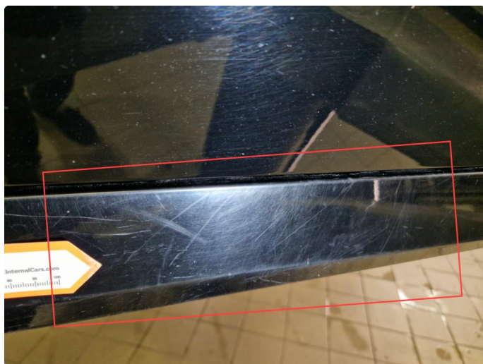
1.5 Riper kanalskjørt h+v side, normal bruksslitasje.
