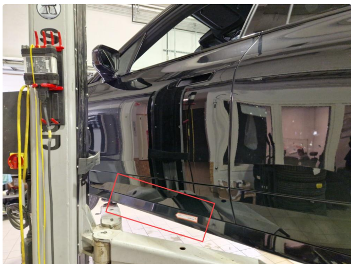
1.5 Riper kanalskjørt h+v side, normal bruksslitasje.
