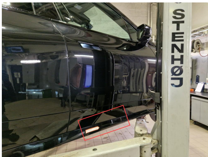
1.5 Riper kanalskjørt h+v side, normal bruksslitasje.
