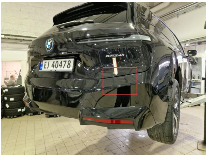
1.3 Noe riper bakfanger / innlastingssone, normal bruksslitasje.
