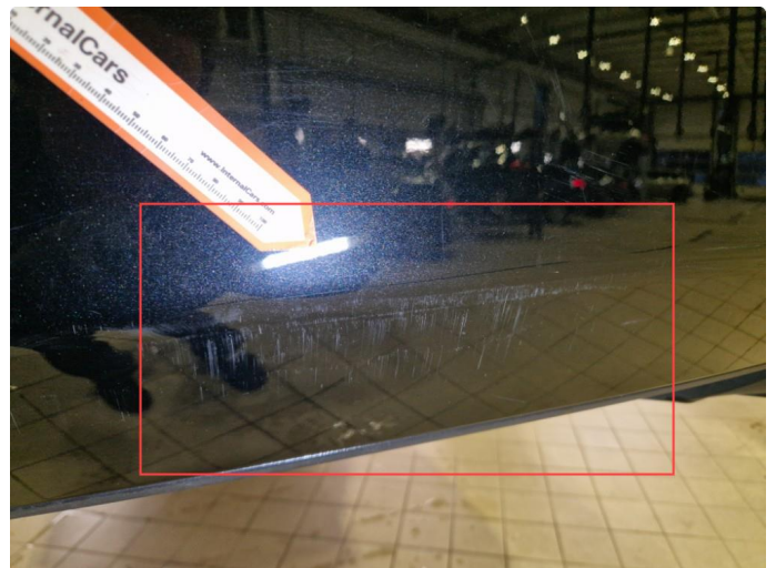
1.3 Noe riper bakfanger / innlastingssone, normal bruksslitasje.
