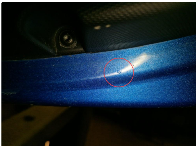
2.2 Noen rustbobler innside nedre del v2-framdør, h+v bakdør.
