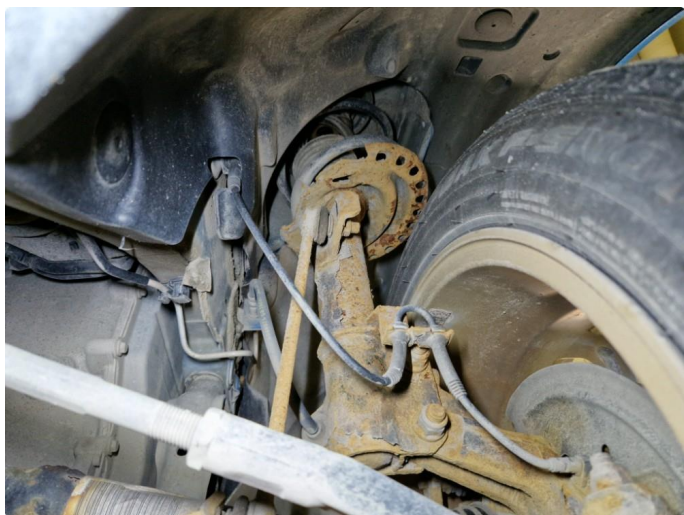
4.3 Noe rustdannelse alle støtdempere.
