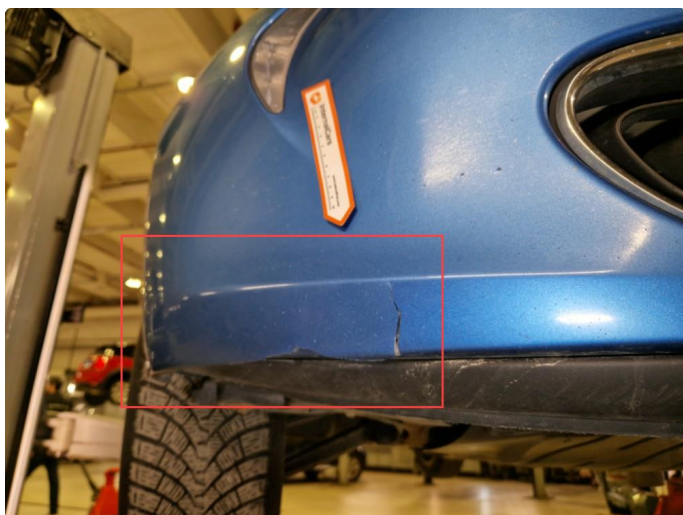
2.11 Skade h-side nedre del frontfanger.
