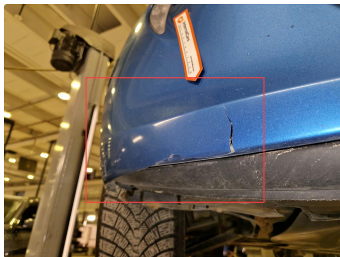
2.11 Skade h-side nedre del frontfanger.
