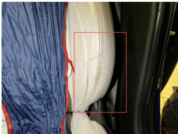
3.2 Noe slitasje førersete.
