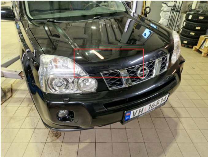
1.1 Steinsprut fremre del panser, er flekket tidligere.
