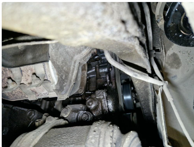
3.1 Oljelekkasje underside og h-side motor, usikkert hvor lekkasje kommer fra.
