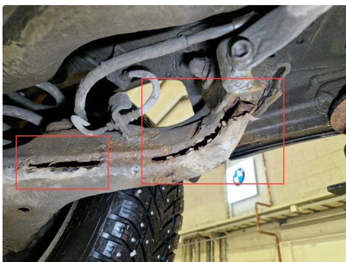
4.1 Gjennomrustet bæream h+v side bak. Mangler store deler av bæream mot fremre foring.
