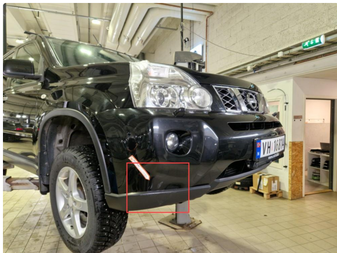
1.7 Lakkskader nedre del h-side frontfanger.
