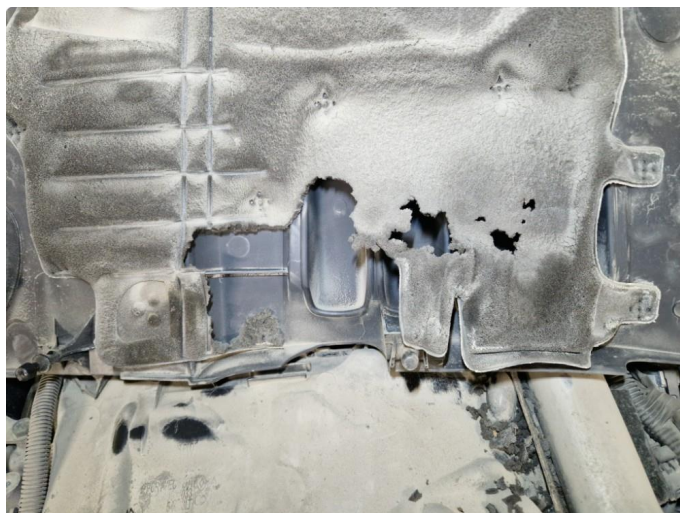
3.5 Spor etter trolig mus under motordeksel, ingen synlige skader på ledninger/slanger. Kun noe skader på filt til motordeksel.
