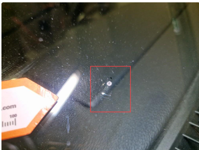
1.9 Steinsprut h-side frontrute, er reparert tidligere.
