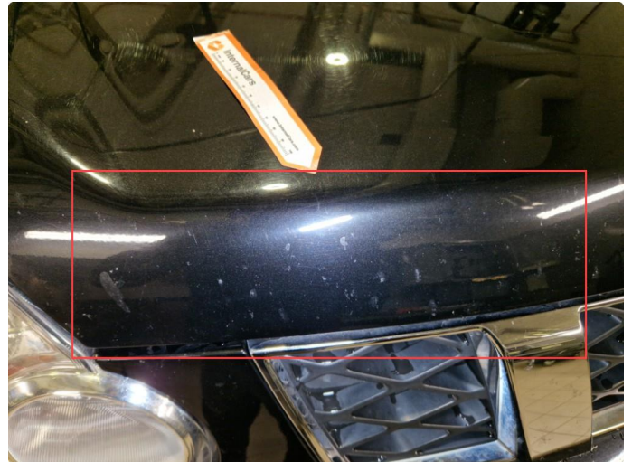
1.1 Steinsprut fremre del panser, er flekket tidligere.
