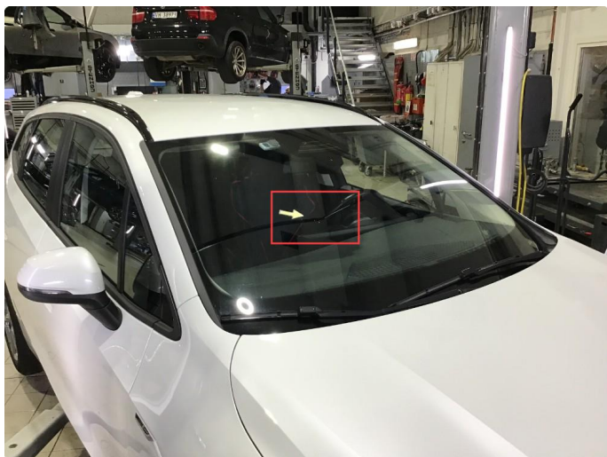
1.4 Noe steinsprut frontrute, for små til å repareres.
