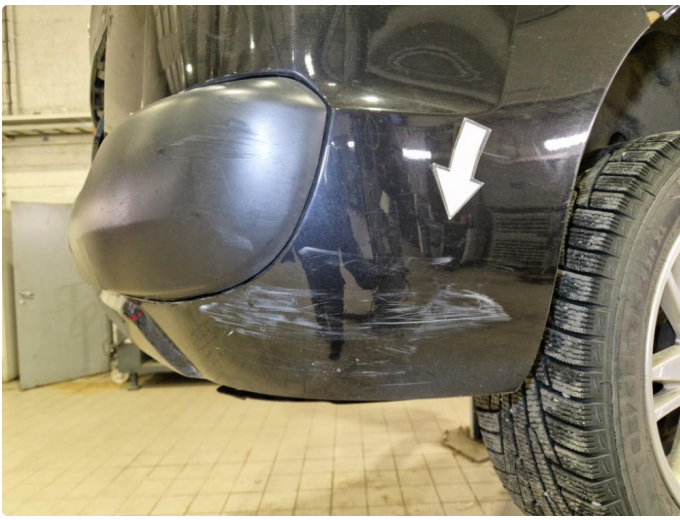
2.17 Riper / skader bakfanger.
