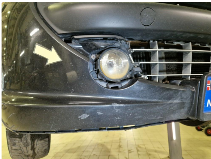
2.16 Skadet frontfanger , mangler deksel rundt tåkelykt h-side.
