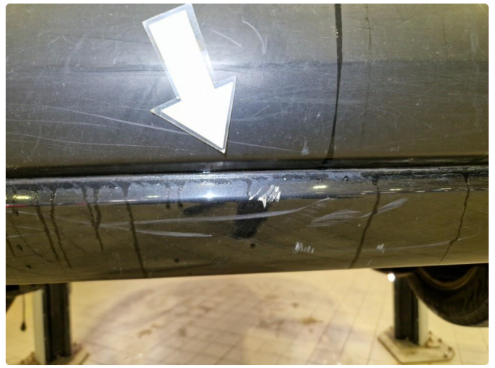
2.17 Riper / skader bakfanger.
