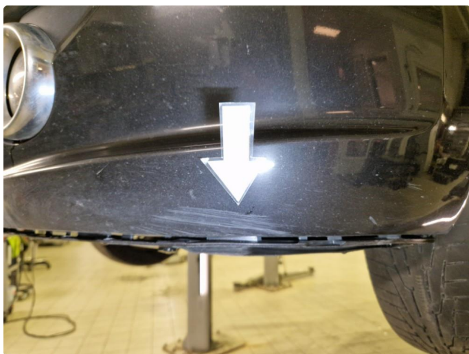
2.16 Skadet frontfanger , mangler deksel rundt tåkelykt h-side.
