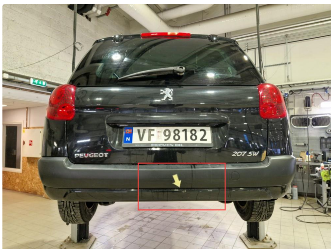
2.17 Riper / skader bakfanger.
