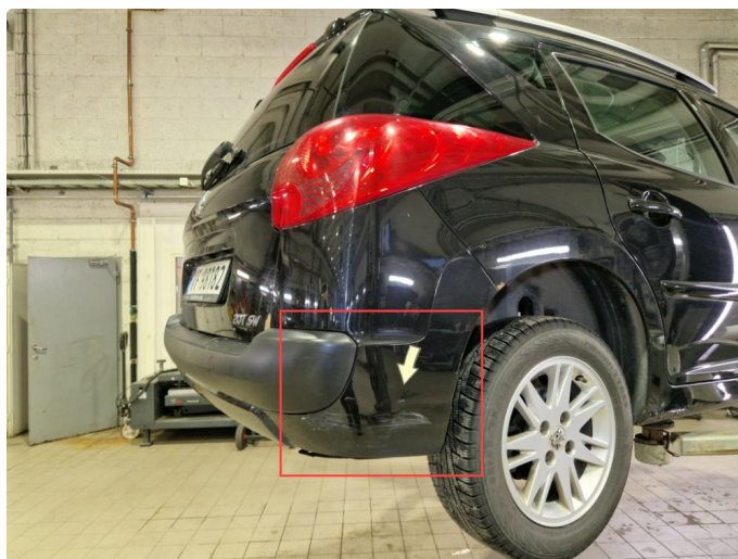
2.17 Riper / skader bakfanger.
