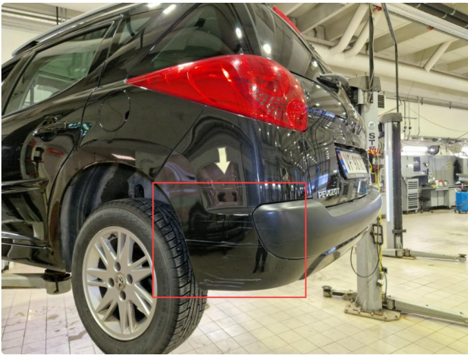
2.17 Riper / skader bakfanger.
