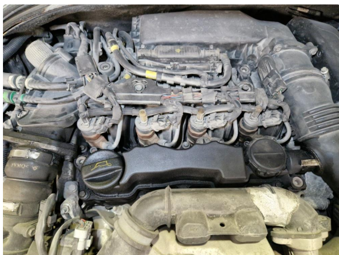
4.1 Oljelekkasje motor / dyser og bunnpannepakning.
