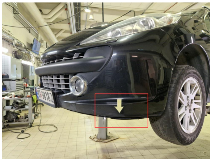
2.16 Skadet frontfanger , mangler deksel rundt tåkelykt h-side.
