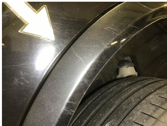
1.3 Noe bruksmerker på skjermutbygger, poleres.
