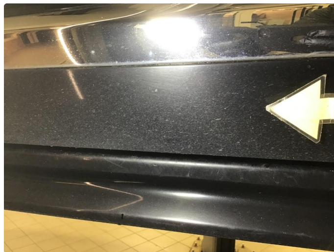
1.2 Noe slitasje lakk på kanaler, poleres.
