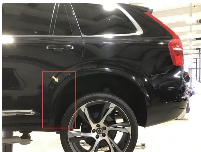
1.3 Noe bruksmerker på skjermutbygger, poleres.
