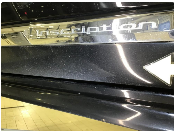
1.2 Noe slitasje lakk på kanaler, poleres.
