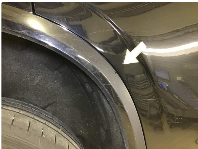
1.3 Noe bruksmerker på skjermutbygger, poleres.
