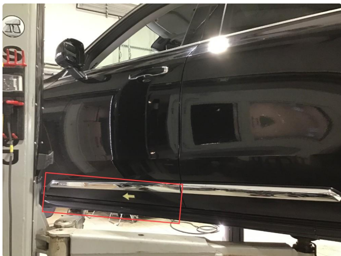
1.2 Noe slitasje lakk på kanaler, poleres.
