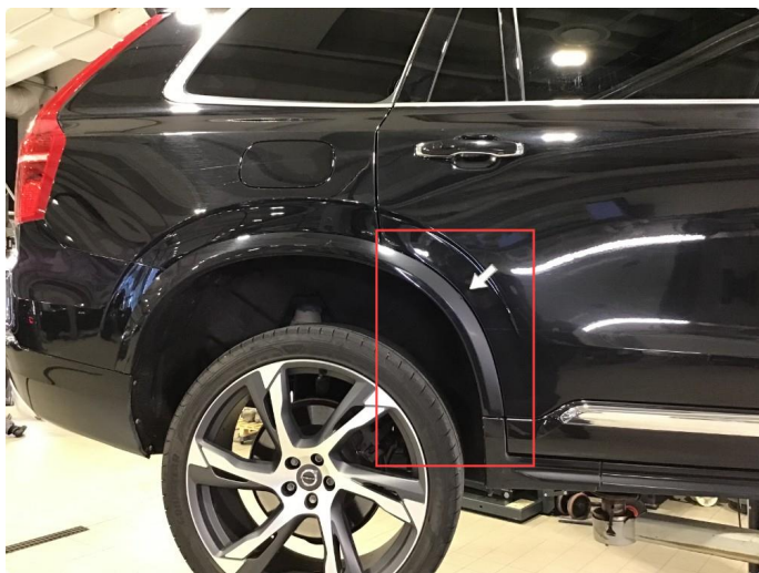
1.3 Noe bruksmerker på skjermutbygger, poleres.
