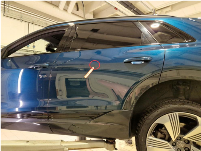
1.1 Liten p-bulk v-bakdør ( Normal bruksslitasje )
