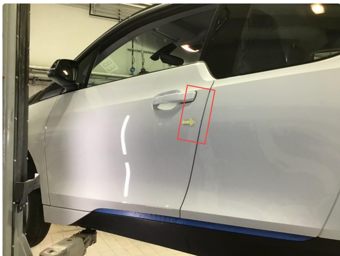
1.2 Lakksår bakre del v-framdør.
