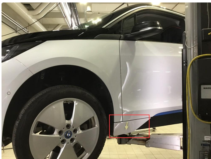
1.8 Noe skrubbermerker underside kanalskjørt v- fram.
