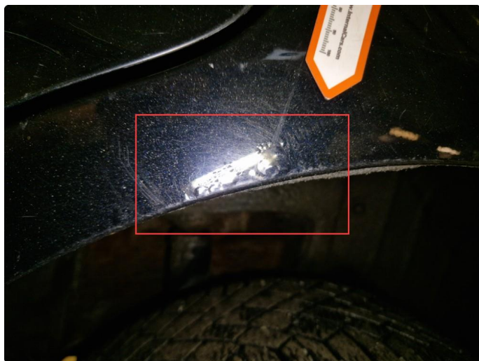
2.4 Rustdannelser v-framskjerm , h+v bakskjerm.
