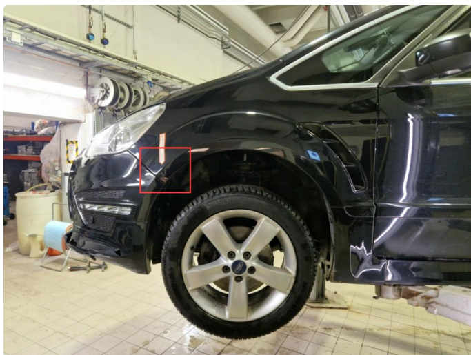
2.4 Rustdannelser v-framskjerm , h+v bakskjerm.
