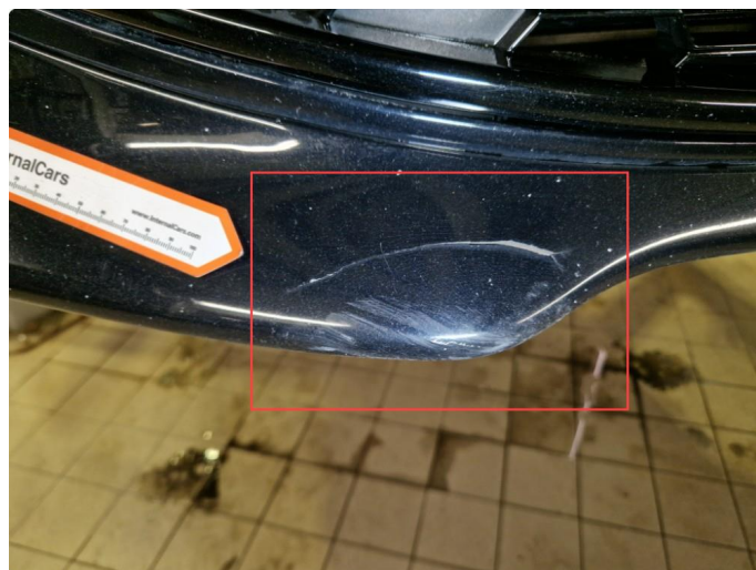
2.10 Skade v-side frontfanger + mangler lyktespylerdeksel v-side.
