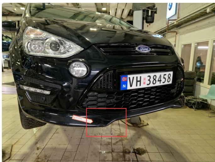
2.10 Skade v-side frontfanger + mangler lyktespylerdeksel v-side.
