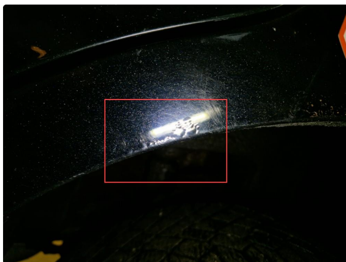
2.4 Rustdannelser v-framskjerm , h+v bakskjerm.
