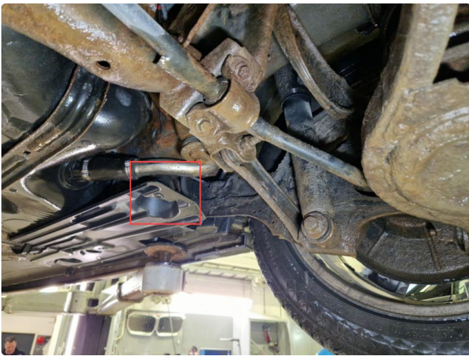
4.1 Slitt / sluppet i vulking fremre bærearmsforing h+v side bak.
