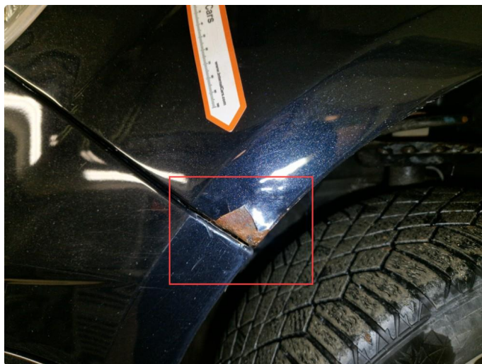
2.4 Rustdannelser v-framskjerm , h+v bakskjerm.
