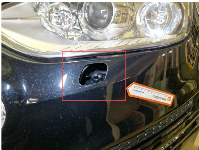
2.10 Skade v-side frontfanger + mangler lyktespylerdeksel v-side.
