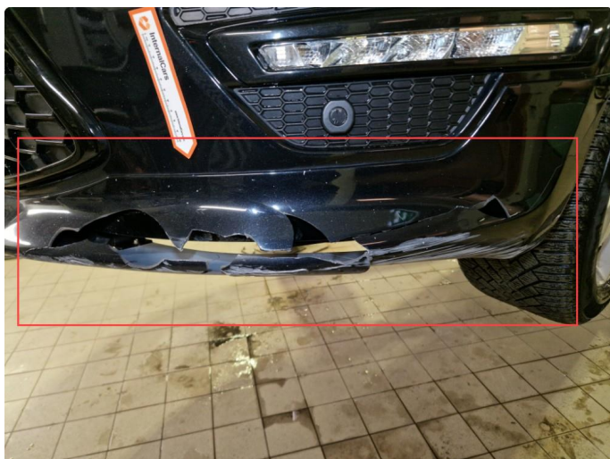
2.10 Skade v-side frontfanger + mangler lyktespylerdeksel v-side.
