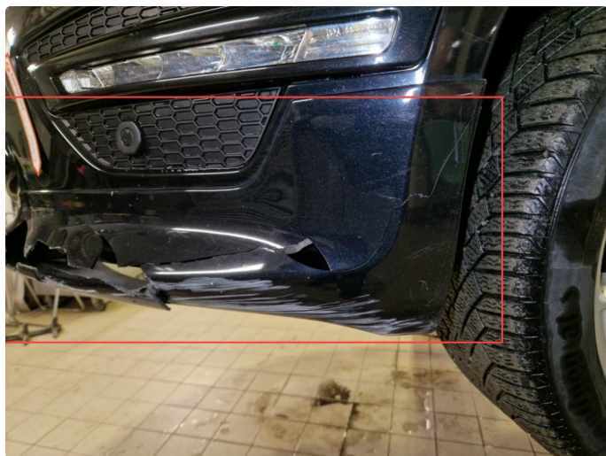
2.10 Skade v-side frontfanger + mangler lyktespylerdeksel v-side.
