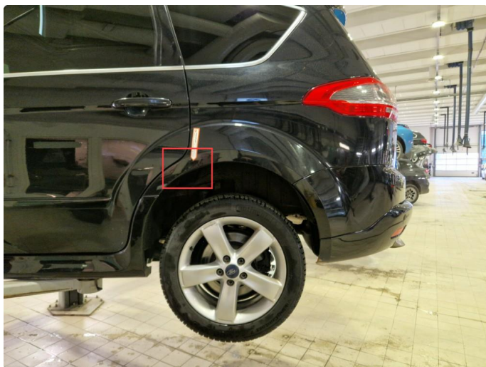
2.4 Rustdannelser v-framskjerm , h+v bakskjerm.
