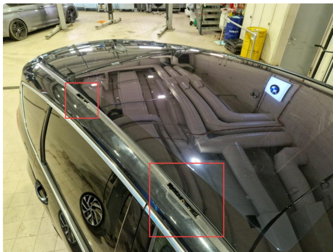
2.12 Mangler deksler over innfesting til lasteholdere.
