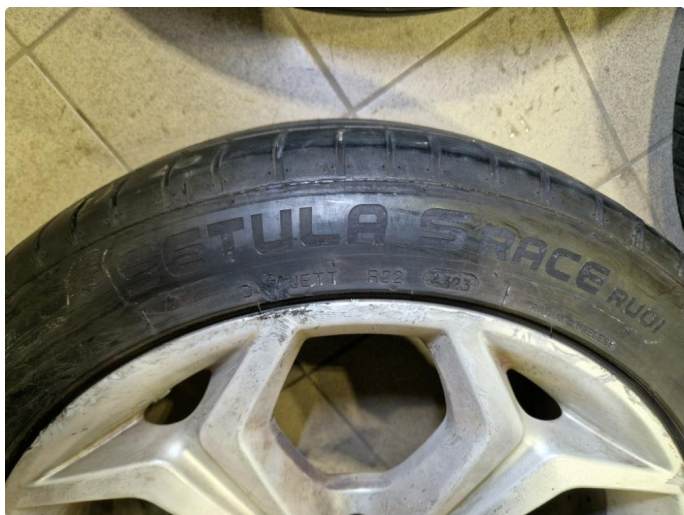
2.5 1 Stk sommerdekk skadet dekkskulder.
