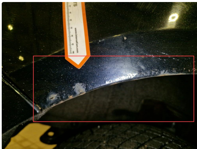
2.4 Rustdannelser v-framskjerm , h+v bakskjerm.
