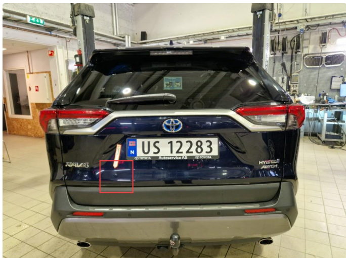
1.1 P-bulk med lakksår bakluke v-side.
