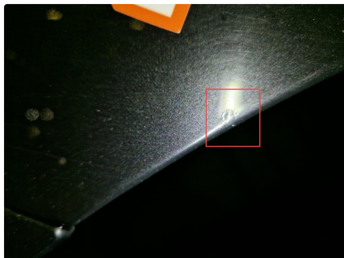
1.2 1 Stk liten rustboble h-bakskjerm, ytre påvirkning. ( Normal bruksslitasje )
