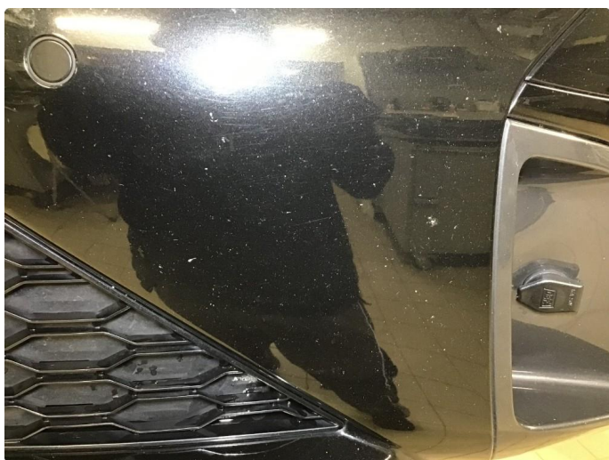
1.4 Noe steinsprut på forntfanger.
