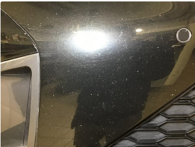
1.4 Noe steinsprut på forntfanger.
