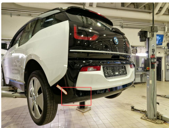
1.6 Noe riper / lakksår bakfanger / innlastingsone , kan poleres / flekkes . ( Normal bruksslitasje )
