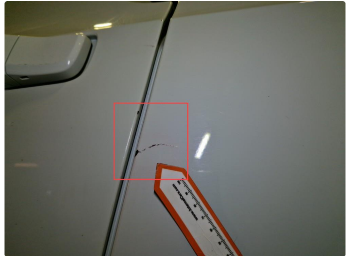
1.1 Noe lakksår fremre del v-bakdør , kan flekkes. ( Normal bruksslitasje )
