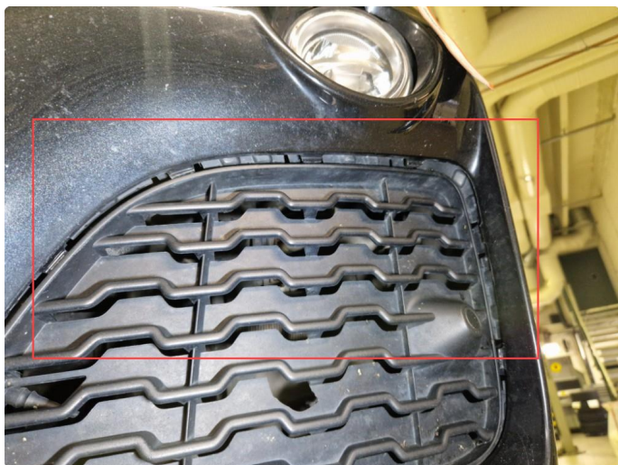
1.10 Lakkskader h-side frontfanger + løs grill v-side.
