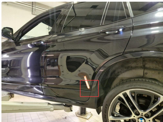
1.4 Rustboble nedre bakre del v-bakdør.
