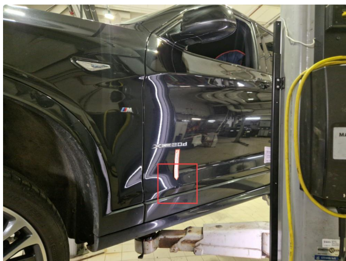
1.3 Noe steinsprut nedre del v-framdør.
