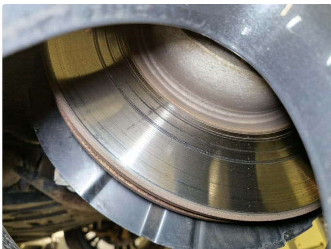
4.1 Pulsering bremseskiver fram , bremseklosser målt til 15mm.
