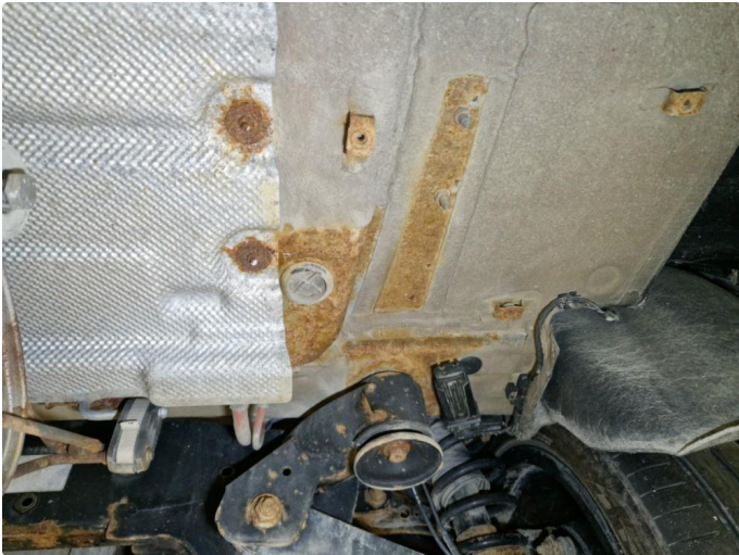
1.1 Rust underside bil, ved bakstilling.
