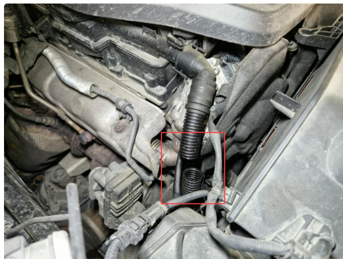
2.4 Skadet / defekt veivhusrør.
