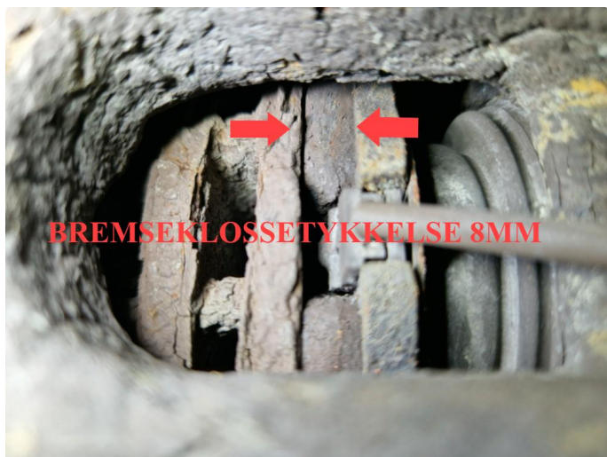
4.2 Rust bremseskiver bak , bremseklosser målt til 8mm.
