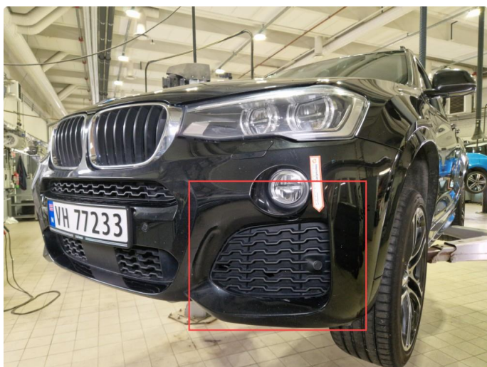
1.10 Lakkskader h-side frontfanger + løs grill v-side.
