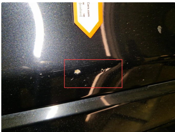
1.3 Noe steinsprut nedre del v-framdør.
