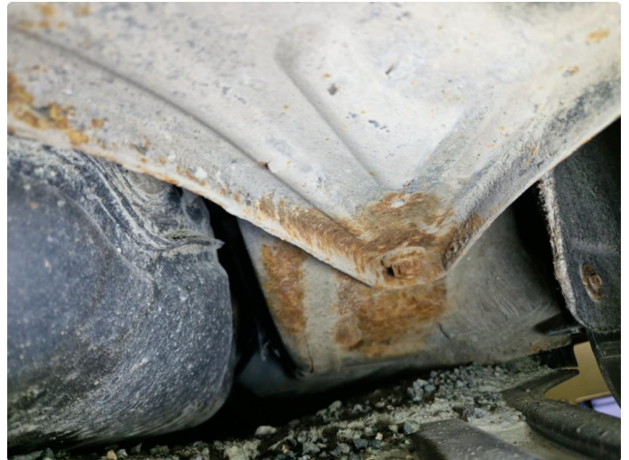
1.1 Rust underside bil, ved bakstilling.
