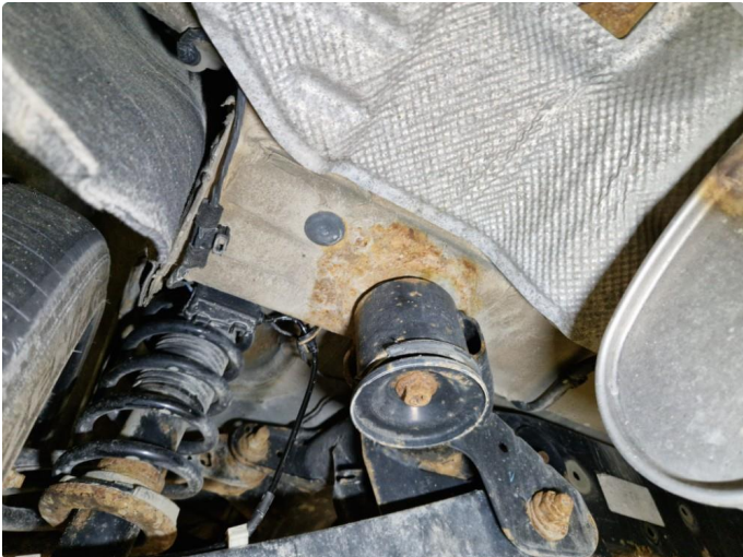
1.1 Rust underside bil, ved bakstilling.
