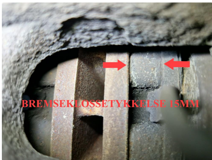
4.1 Pulsering bremseskiver fram , bremseklosser målt til 15mm.
