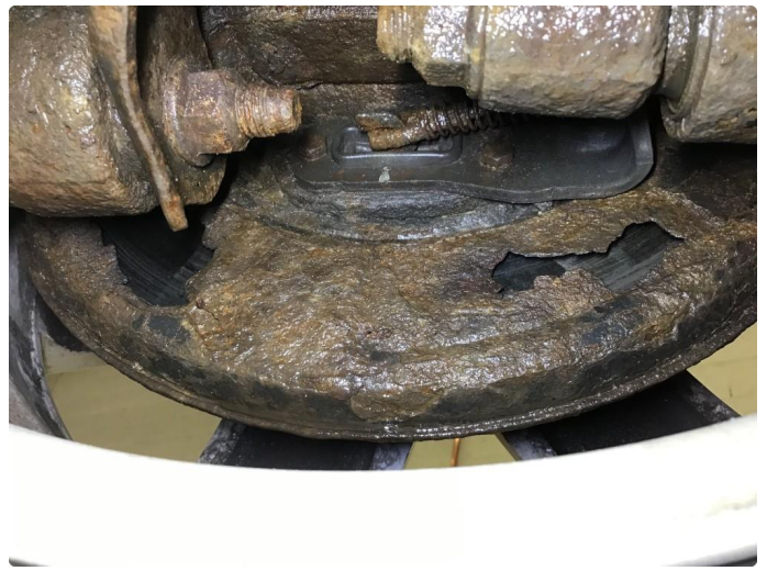
5.5 Opprustet bremseskjold h+v bak.
