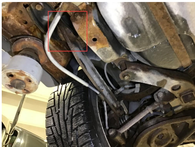
4.2 Utslitt fremre bæreamsforing h+ v bak.
