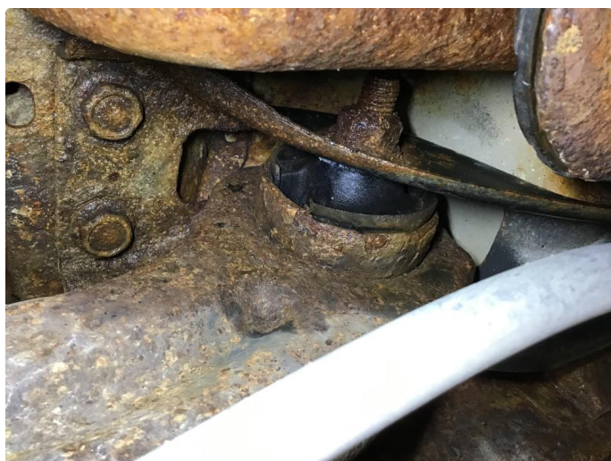
4.2 Utslitt fremre bæreamsforing h+ v bak.
