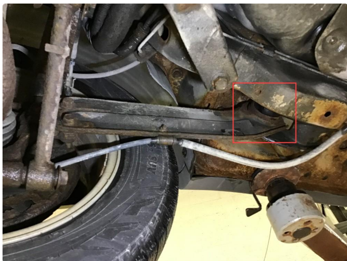
4.2 Utslitt fremre bæreamsforing h+ v bak.
