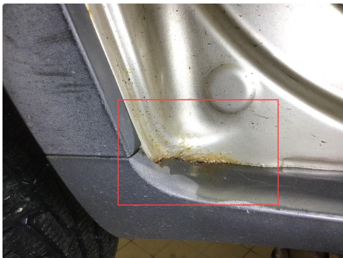
1.11 Rust innsteg h+v bak.
