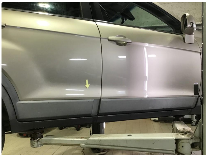
1.2 Mye slitasje / misfarget plastikkdeksler rundt om bil.
