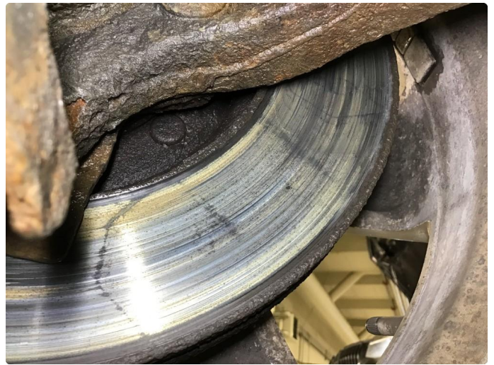
5.5 Opprustet bremseskjold h+v bak.
