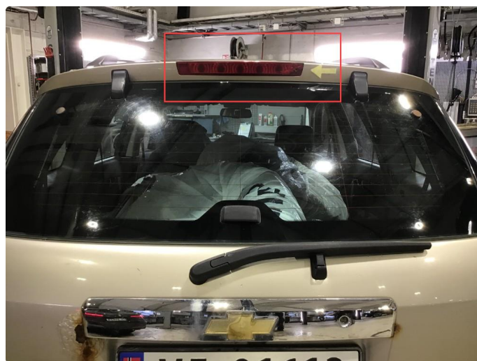
2.2 Sprekkdannelser midtre øvre bremselykt.
