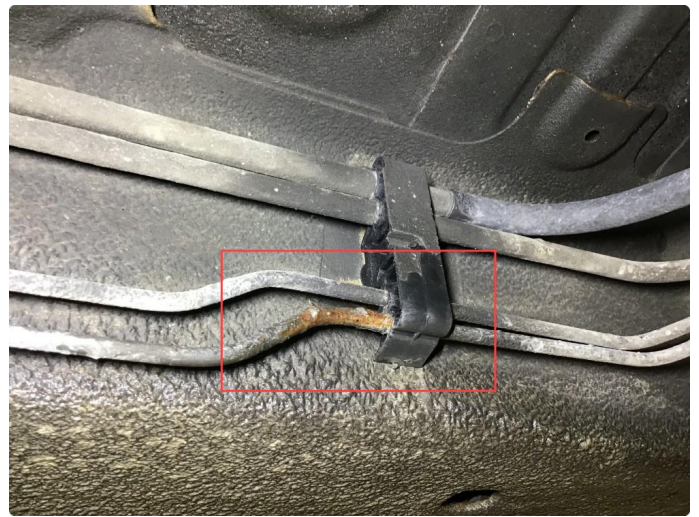
5.2 Rust bremselør h+v side bak + langsgående framover.
