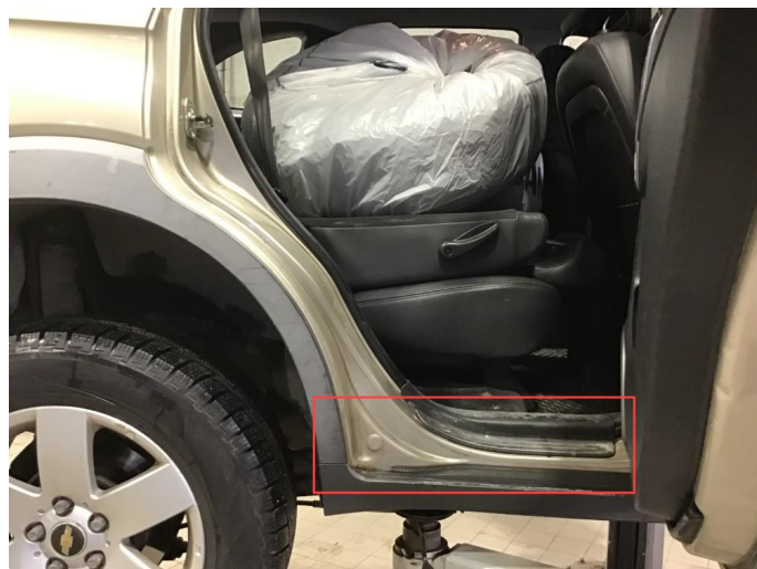
1.11 Rust innsteg h+v bak.
