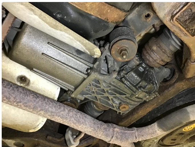
6.2 Lekkasje bakre differensial.
