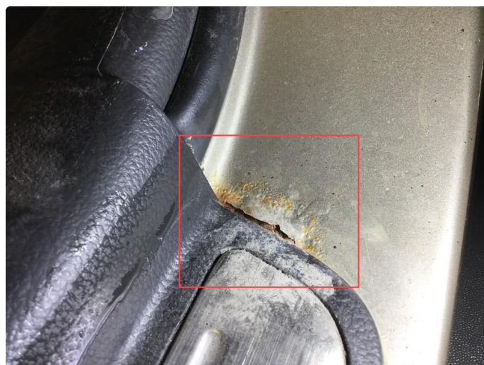
1.11 Rust innsteg h+v bak.
