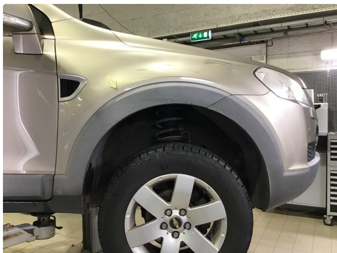
1.2 Mye slitasje / misfarget plastikkdeksler rundt om bil.
