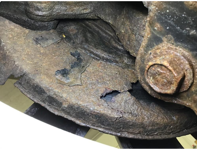
5.5 Opprustet bremseskjold h+v bak.
