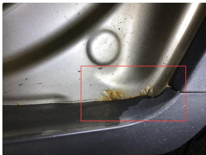
1.11 Rust innsteg h+v bak.
