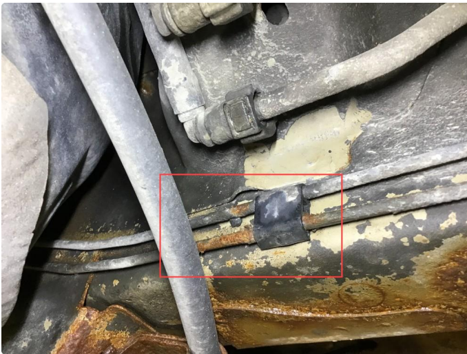
5.2 Rust bremselør h+v side bak + langsgående framover.
