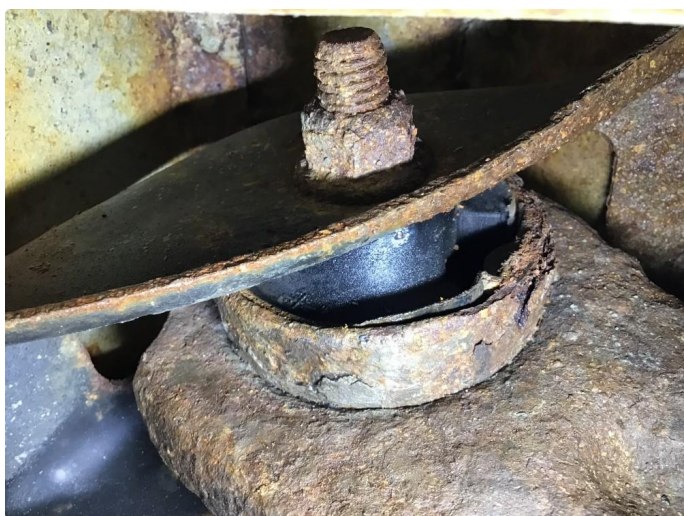
4.2 Utslitt fremre bæreamsforing h+ v bak.
