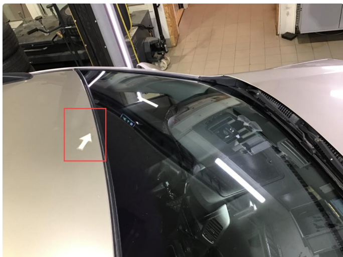
1.13 Rust + bulker fremre del tak.
