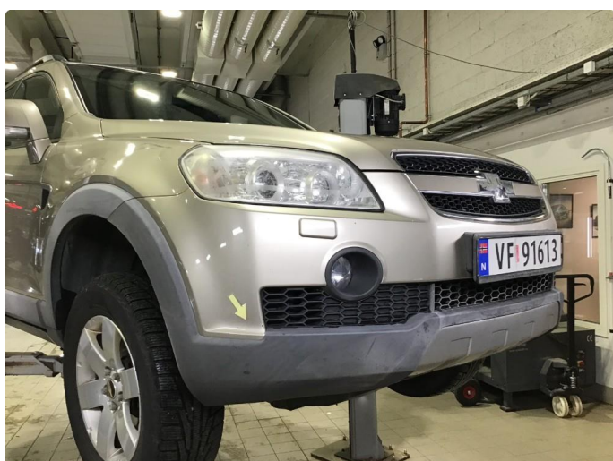
1.2 Mye slitasje / misfarget plastikkdeksler rundt om bil.
