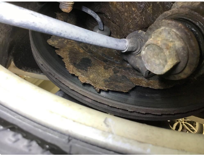
5.5 Opprustet bremseskjold h+v bak.
