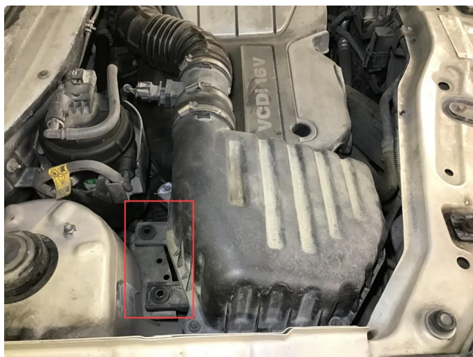
3.5 Mangler 2 stk bolter til luftfilterboks.
