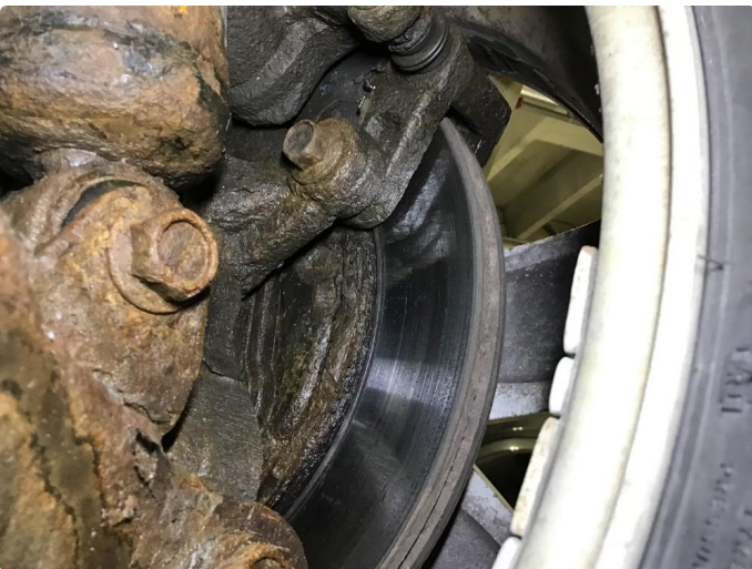
5.5 Opprustet bremseskjold h+v bak.
