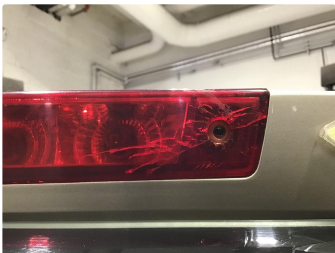
2.2 Sprekkdannelser midtre øvre bremselykt.
