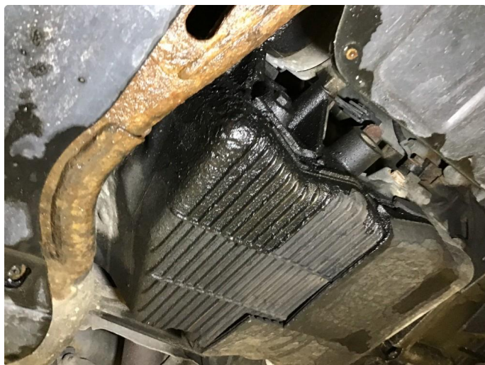
3.2 Oljelekkasje veivhusventilasjon + underside motor.
