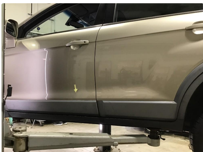
1.2 Mye slitasje / misfarget plastikkdeksler rundt om bil.
