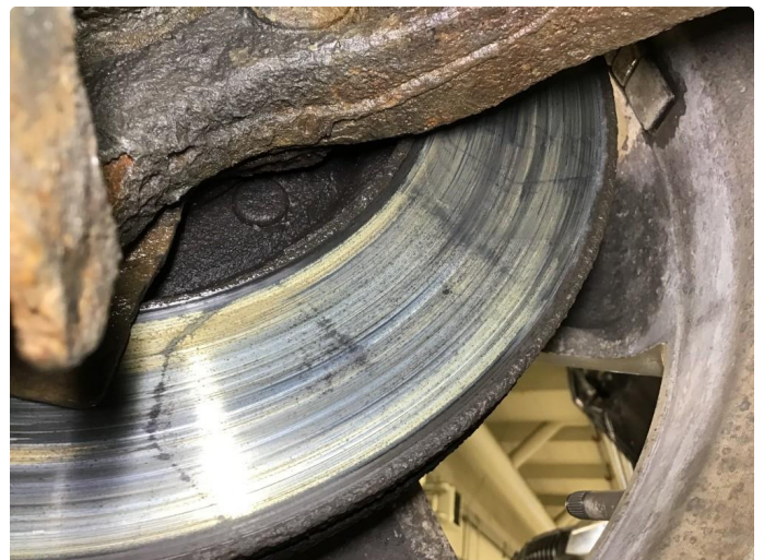
5.4 Slitte / stor slitte kant bremseskiver fram, bremseløser målt til 4mm.
