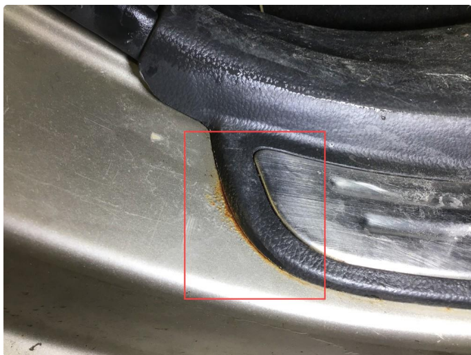
1.11 Rust innsteg h+v bak.
