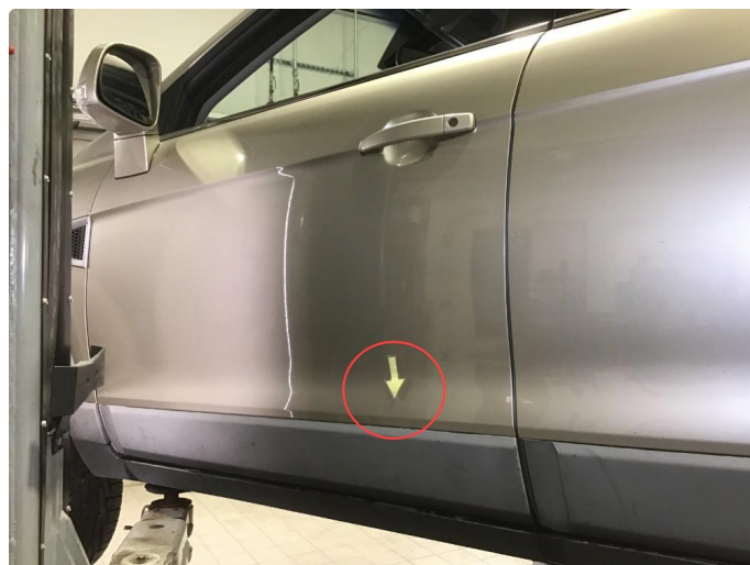
1.5 Flere p-bulker + rust ved dørhåndtak v- framdør.
