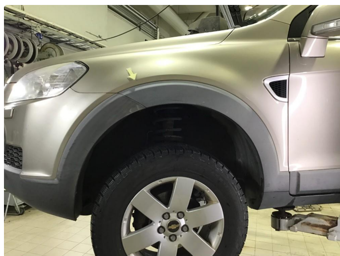
1.2 Mye slitasje / misfarget plastikkdeksler rundt om bil.
