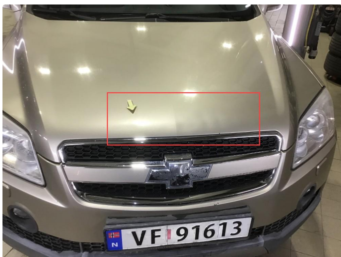
1.4 Rust inside bakre del panser + bulker fremre del.
