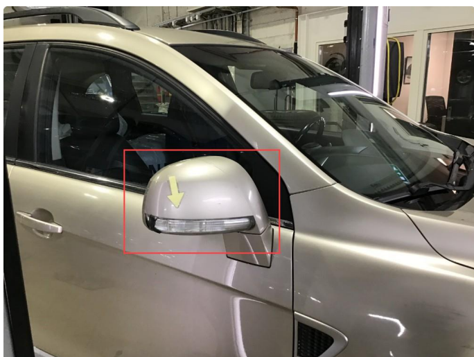
2.3 Skadet blinklykt h-side.
