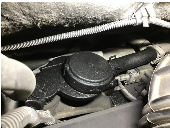
3.2 Oljelekkasje veivhusventilasjon + underside motor.
