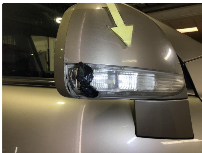
2.3 Skadet blinklykt h-side.
