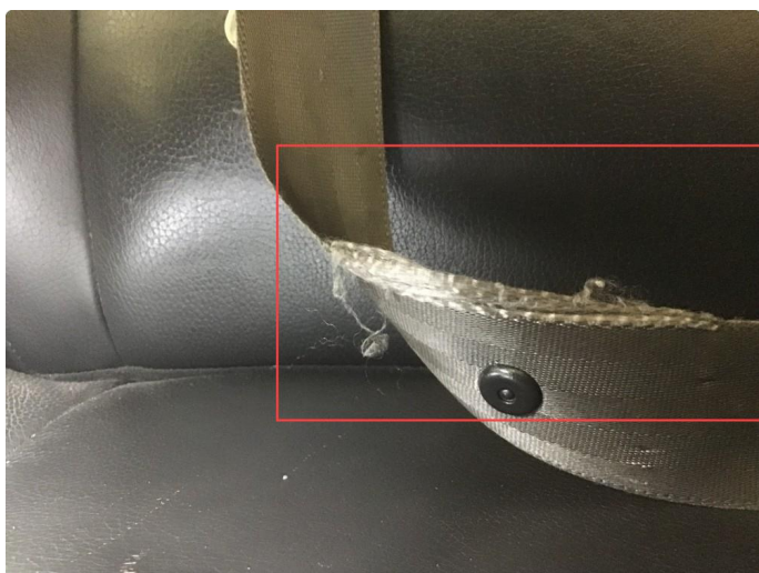
7.1 Skadet sikkerhetsbelte v-fram , oppfliset.
