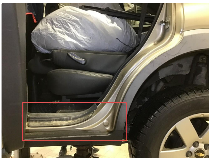
1.11 Rust innsteg h+v bak.
