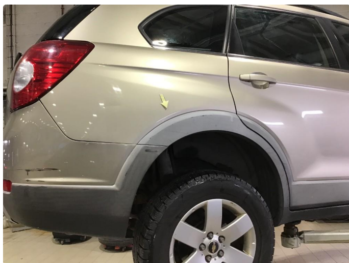
1.2 Mye slitasje / misfarget plastikkdeksler rundt om bil.
