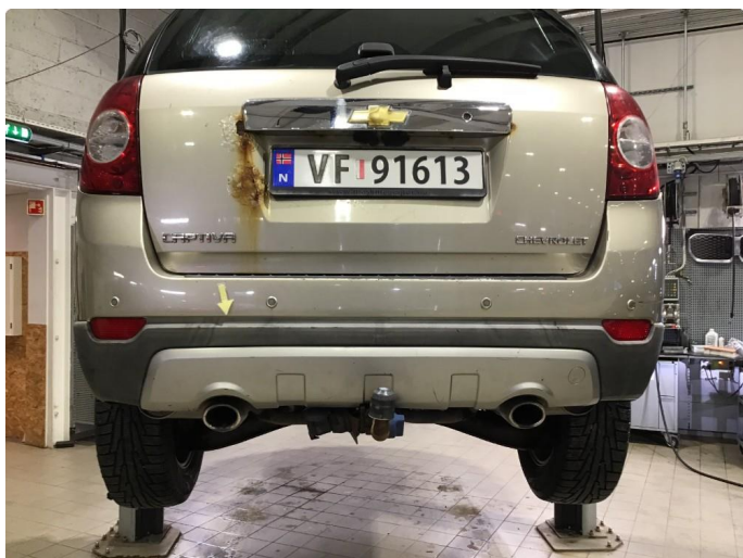
1.2 Mye slitasje / misfarget plastikkdeksler rundt om bil.
