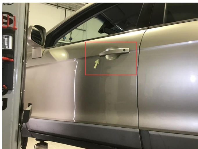
1.5 Flere p-bulker + rust ved dørhåndtak v- framdør.
