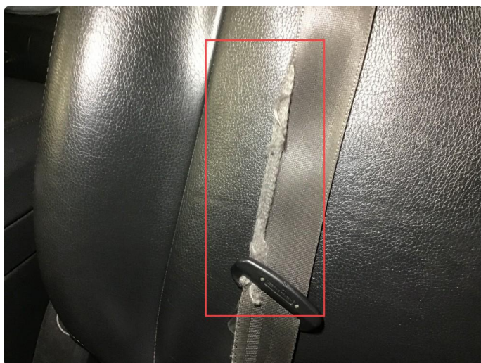
7.1 Skadet sikkerhetsbelte v-fram , oppfliset.
