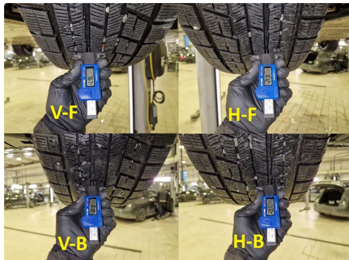
1.3 Dekkdybdemåling vinterdekk utført 29.01.2026 på km : 11.806
