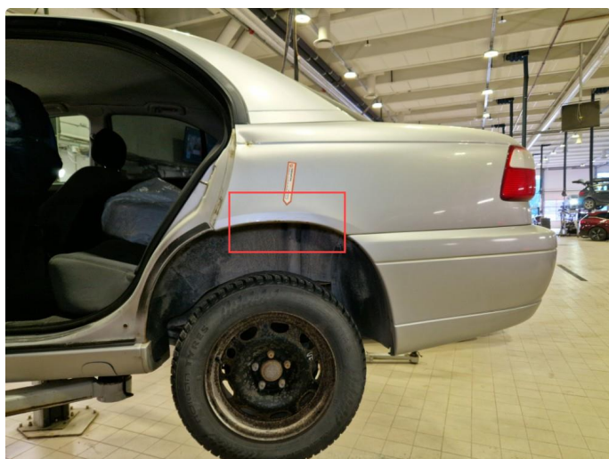
1.5 Rust / skader v-bakskjerm.
