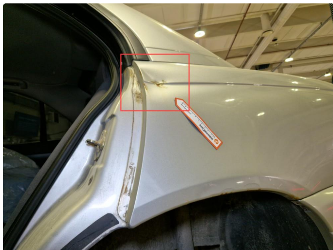
1.5 Rust / skader v-bakskjerm.
