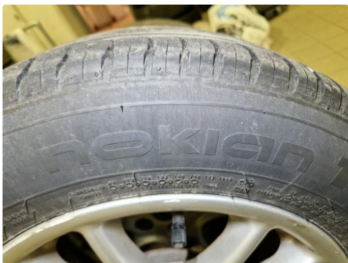
1.7 2 Stk sommerdekk slitasje. Nokian Nordman SX2 195/65R 15 91H.
