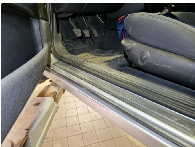
1.12 Skadet dørkarmlist v-fram.
