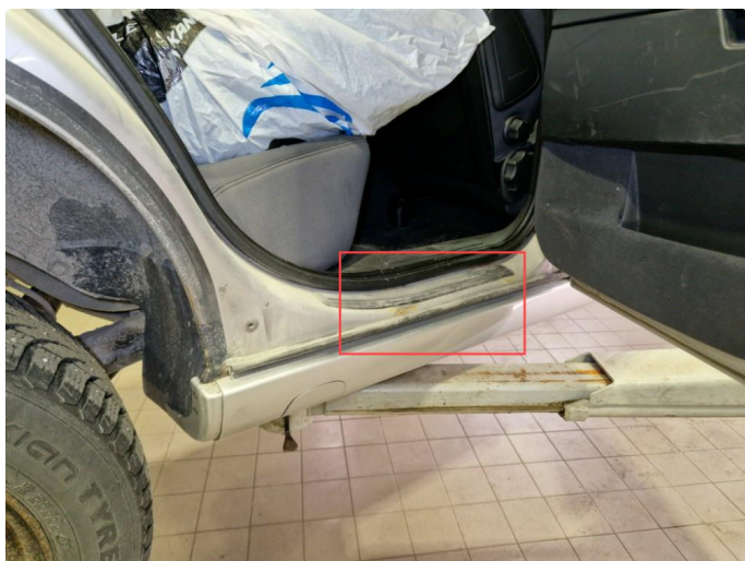
1.11 Rust dørstokk / døråpning h-bak.
