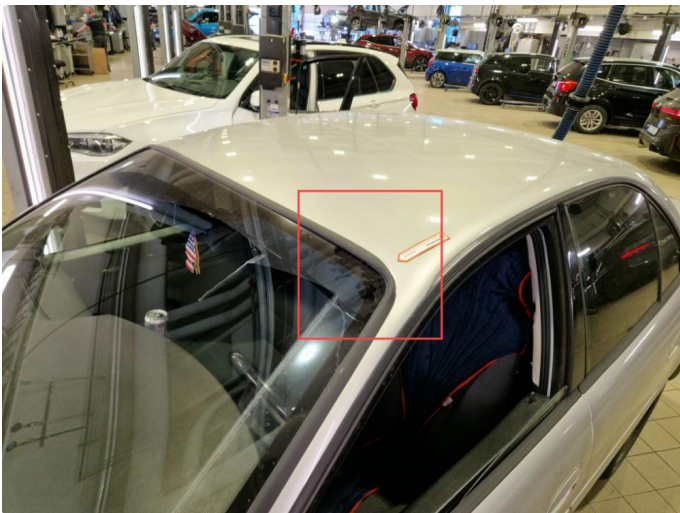
1.14 Skadet / løs list øvre del frontrute.
