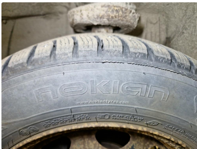
1.8 Vinterdekk produsert 32/2011 Nokian Hakkapelitta 7 195/65R 15 95T Piggdekk.
