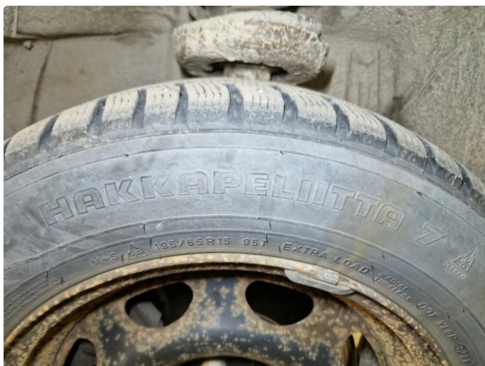
1.8 Vinterdekk produsert 32/2011 Nokian Hakkapelitta 7 195/65R 15 95T Piggdekk.
