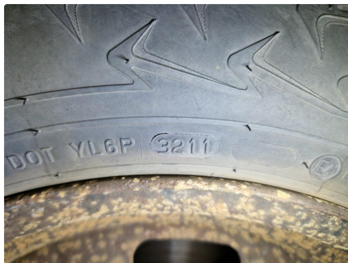
1.8 Vinterdekk produsert 32/2011 Nokian Hakkapelitta 7 195/65R 15 95T Piggdekk.
