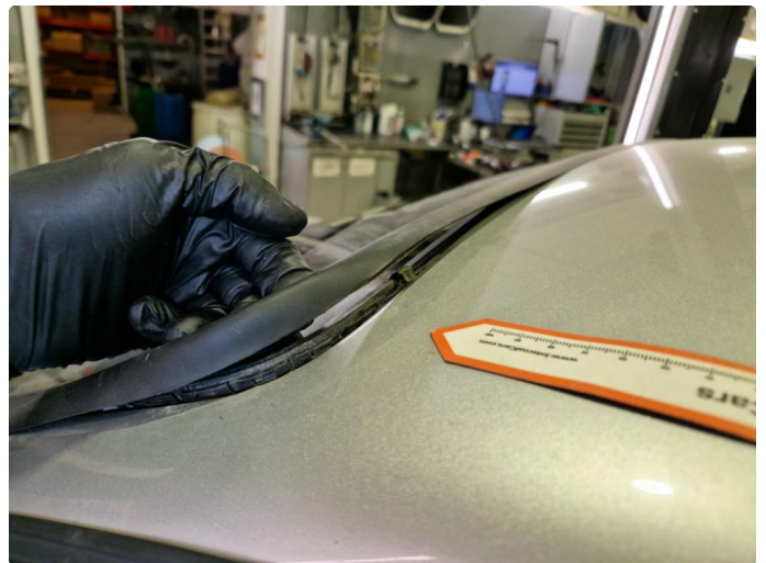
1.14 Skadet / løs list øvre del frontrute.
