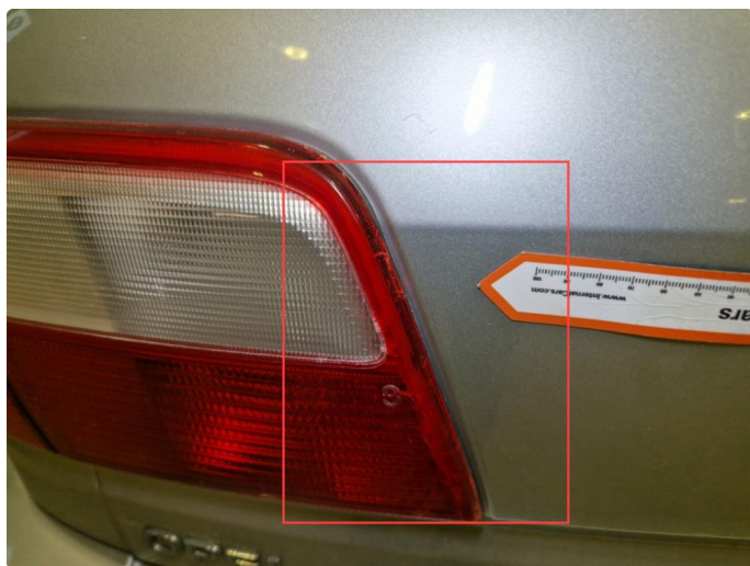
2.1 Noen sprekke-dannelser lykteglass indre baklykt h+v side.
