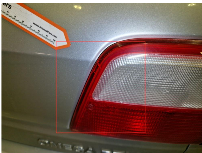
2.1 Noen sprekke-dannelser lykteglass indre baklykt h+v side.
