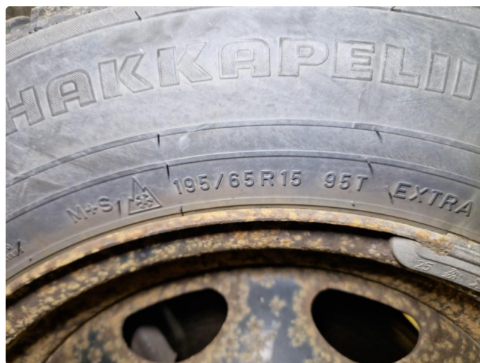
1.8 Vinterdekk produsert 32/2011 Nokian Hakkapelitta 7 195/65R 15 95T Piggdekk.
