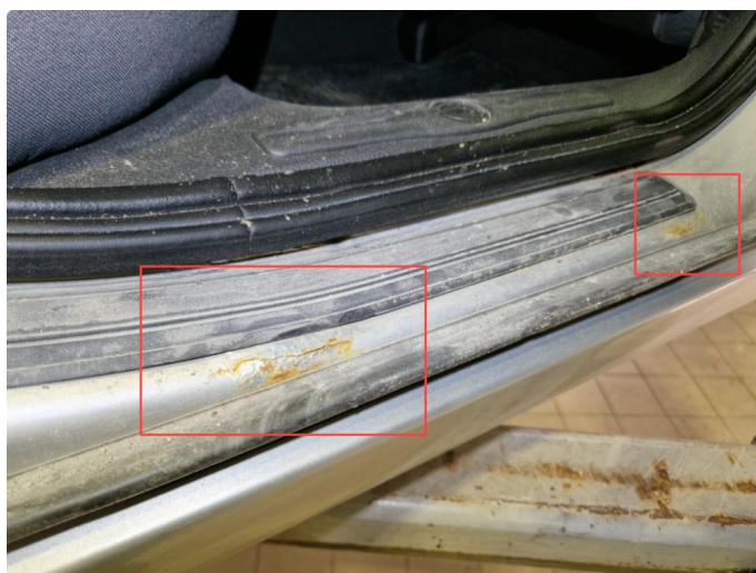
1.11 Rust dørstokk / døråpning h-bak.
