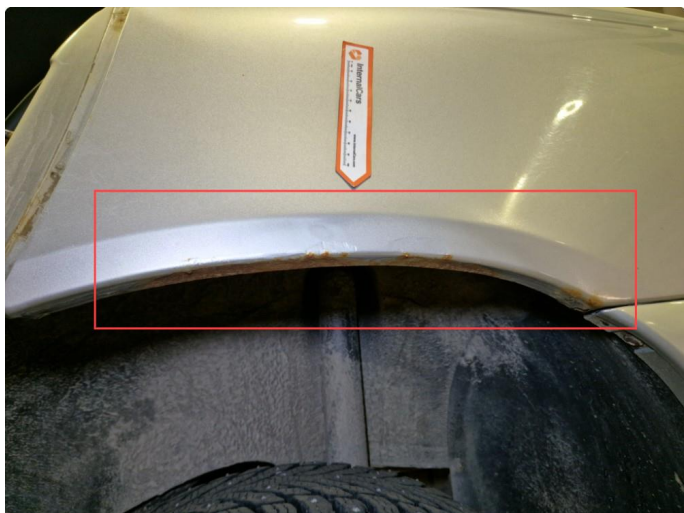
1.5 Rust / skader v-bakskjerm.
