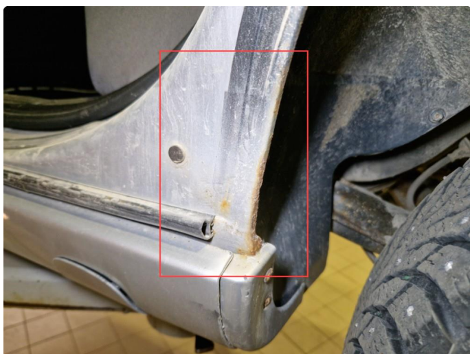
1.5 Rust / skader v-bakskjerm.
