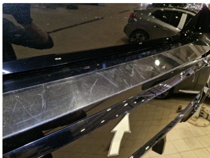
1.5 Noe bruksslitasje på innlastingssone bakfanger, poleres.
