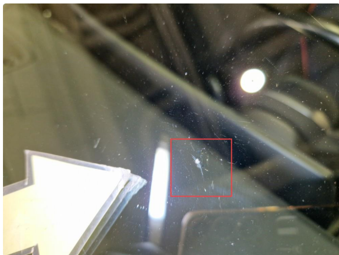
1.6 Steinsprut på frontrute, reparert.
