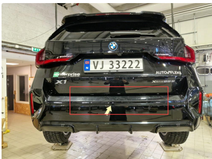
1.5 Noe bruksslitasje på innlastingssone bakfanger, poleres.
