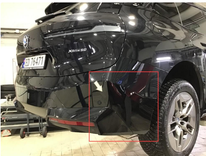
1.1 Noen bruksmerker på støtfanger bak, poleres.
