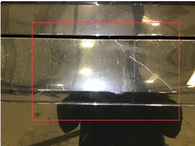
1.1 Noen bruksmerker på støtfanger bak, poleres.
