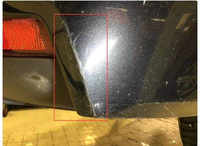
1.1 Noen bruksmerker på støtfanger bak, poleres.
