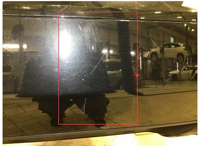
1.1 Noen bruksmerker på støtfanger bak, poleres.
