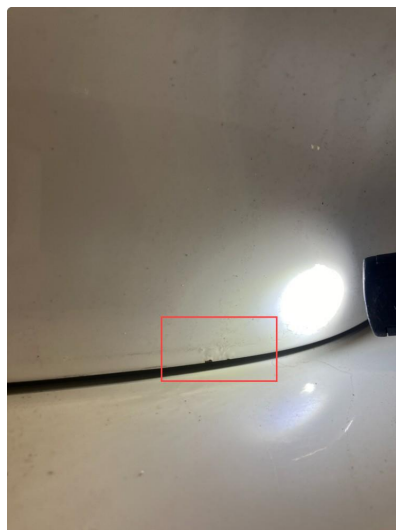
1.2 Noe korrosjon nedre del bakluke, normal ihht alder og kjørelengde.
