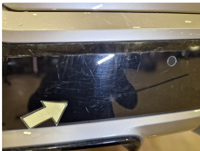
1.3 Noen bruksriper på støtfanger bak, poleres.
