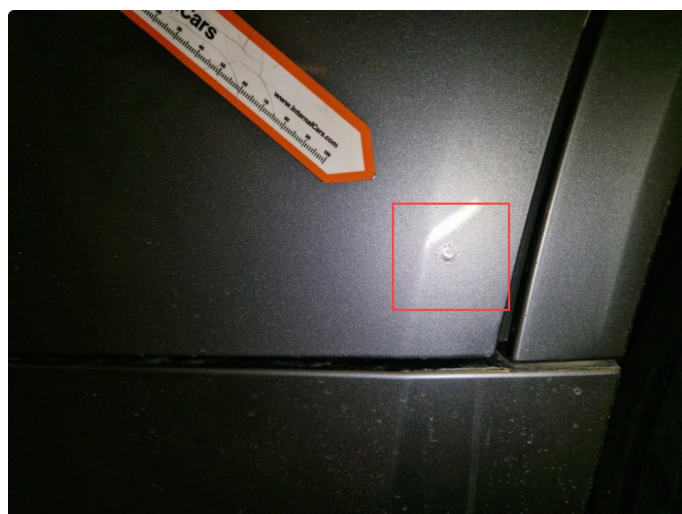
1.2 Noen zinkblærer og bruksmerker på bilen, ikke ut over normal ihht alder og kjørelengde.
