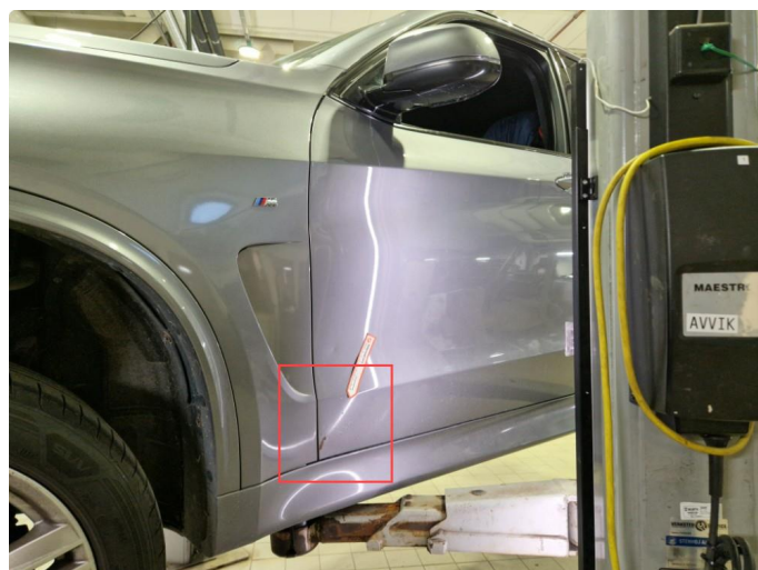
1.1 Noen zinkblærer og bruksmerker på bilen, ikke ut over normal ihht alder og kjørelengde.
