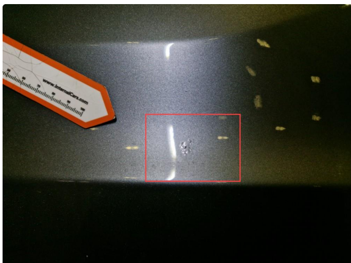
1.5 Noen zinkblærer og bruksmerker på bilen, ikke ut over normal ihht alder og kjørelengde.
