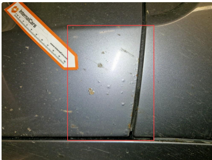
1.4 Noen zinkblærer og bruksmerker på bilen, ikke ut over normal ihht alder og kjørelengde.
