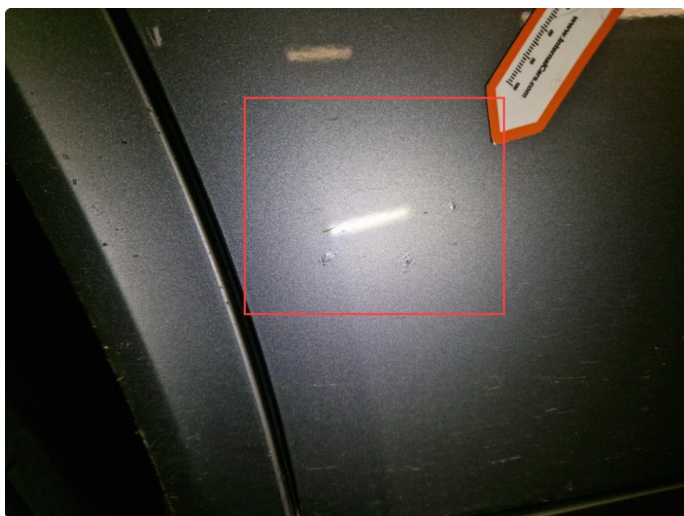
1.3 Noen zinkblærer og bruksmerker på bilen, ikke ut over normal ihht alder og kjørelengde.
