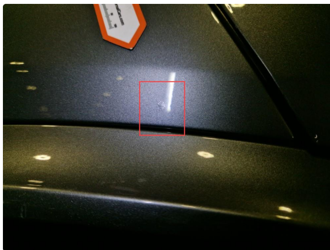
1.7 Noen zinkblærer og bruksmerker på bilen, ikke ut over normal ihht alder og kjørelengde.
