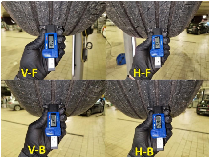
1.1 Dekkdybdemåling sommerdekk utført 01.07.2025
