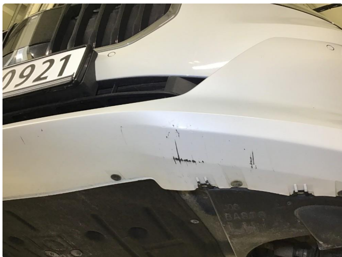
2.5 Noen skrubbermerker underkant fremfanger, regnes som normal bruksslitasje.
