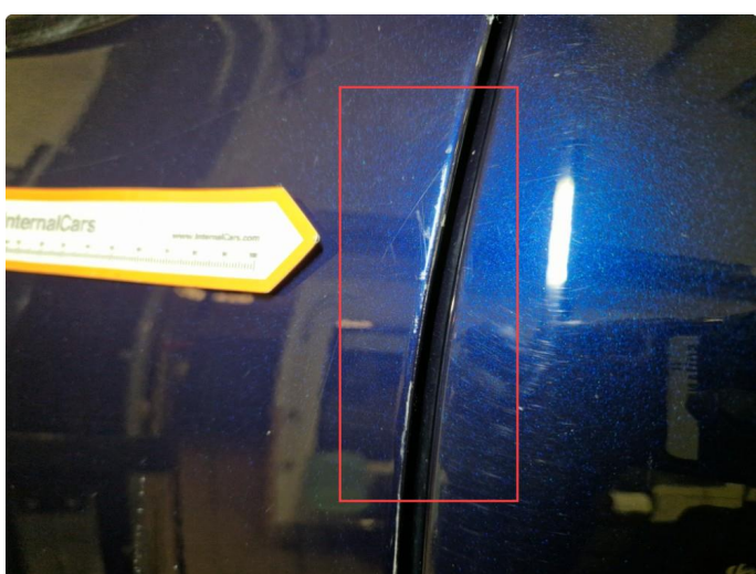
1.2 Noe bruksmerker på dør, normal bruksslitasje.
