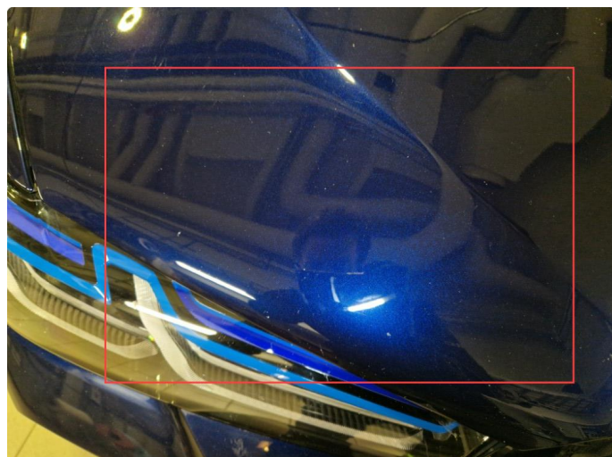
1.1 Noe steinsprut panser.
