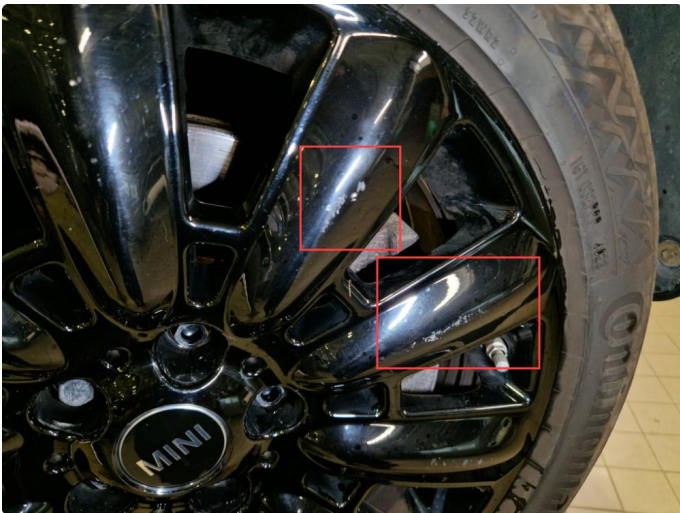
1.2 Noe små sår alle sommerfelger ( Normal bruksslitasje ) .
