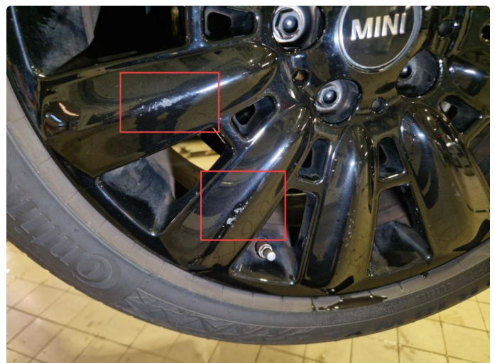
1.2 Noe små sår alle sommerfelger ( Normal bruksslitasje ) .
