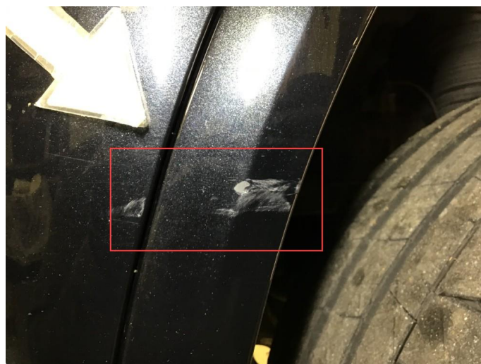
1.3 Noe riper på skjemutbygger v-side fremme, flekkes og poleres.
