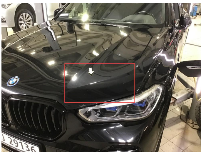
1.2 Noe steinsprut på panser, flekkes og poleres.
