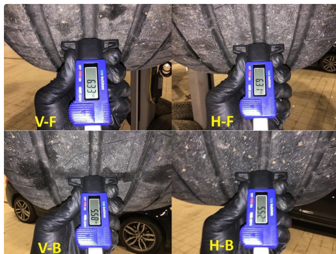
1.4 Mønsterdybde sommerdekk målt ved takst 25.10.2024, 91.750km.
