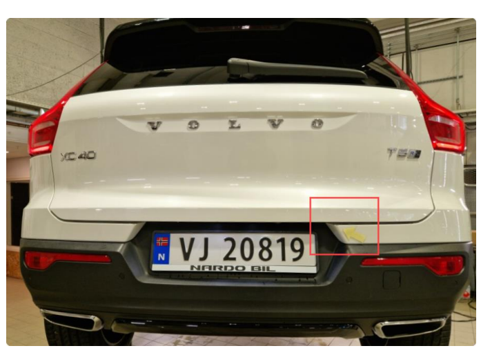
1.3 Lakksår midtre del h+v side bakfanger / innlastingsone.
