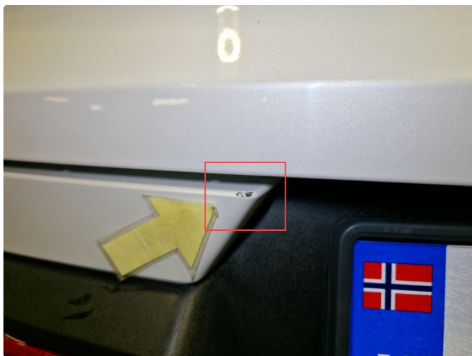
1.3 Lakksår midtre del h+v side bakfanger / innlastingssone.
