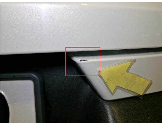
1.3 Lakksår midtre del h+v side bakfanger / innlastingsone.
