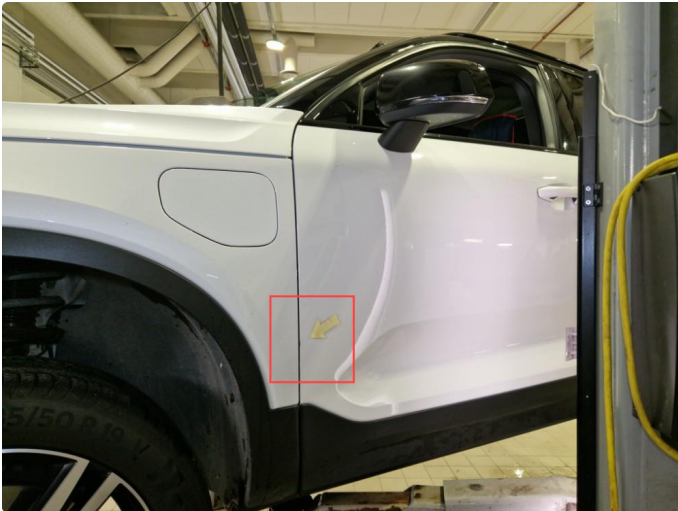
1.1 Lakksår fremre del v-framdør.
