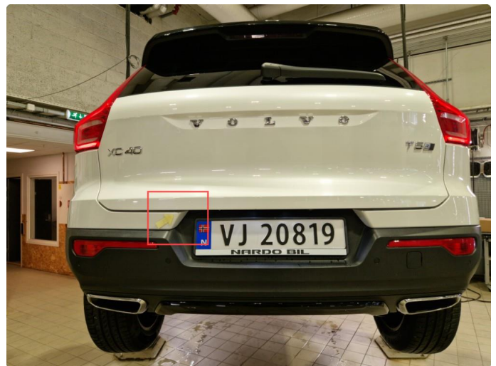
1.3 Lakksår midtre del h+v side bakfanger / innlastingsone.
