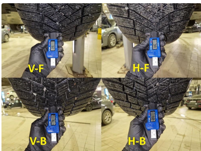
1.3 Dekkdybdemåling vinterdekk utført 10.03.2026 på km : 96.809.
