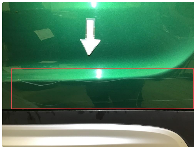
1.2 Langsgående riper nedre del v-fram og bakdør ( Poleres )
