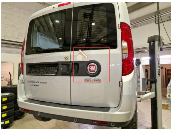
2.4 Rustbobler ved deksel bakluke h-side.
