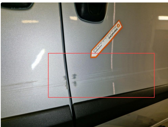
2.1 Lakkskader / riper h-framdør.
