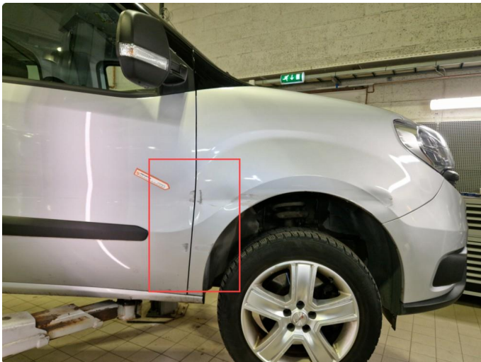
2.1 Lakkskader / riper h-framdør.
