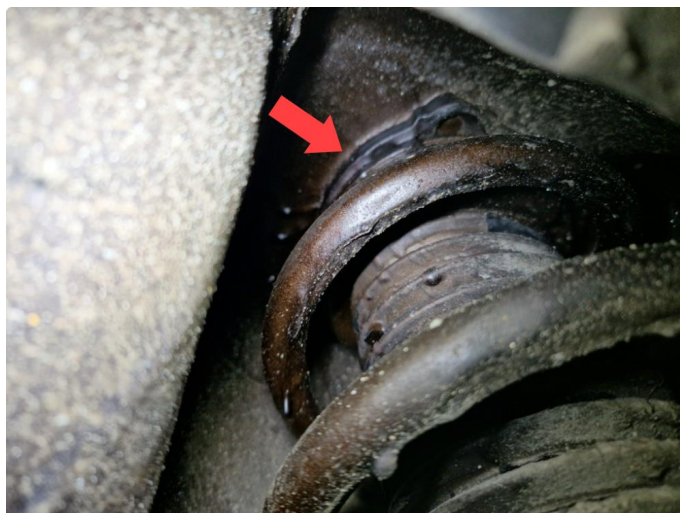
4.1 Treghet / lugging fjærbeinslager v-side fram , fjær hopper frem og tilbake ved sving.
