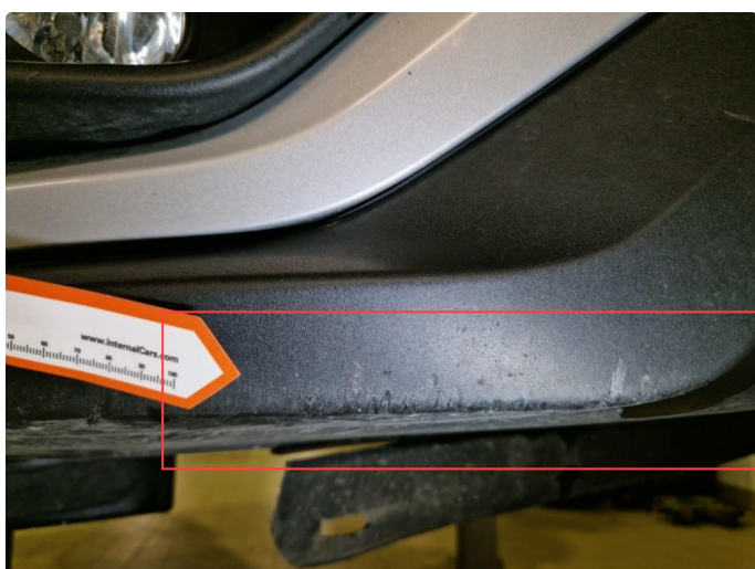
2.13 Noe skrubbskader / riper nedre del h-side frontfanger.
