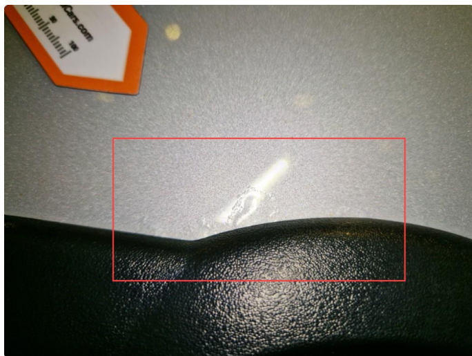
2.4 Rustbobler ved deksel bakluke h-side.
