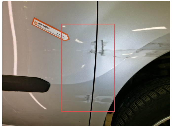
2.1 Lakkskader / riper h-framdør.
