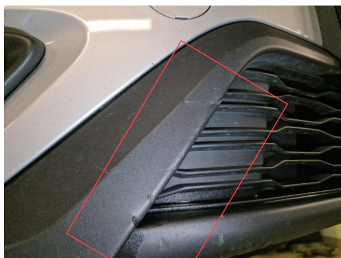
2.13 Noe skrubbskader / riper nedre del h-side frontfanger.
