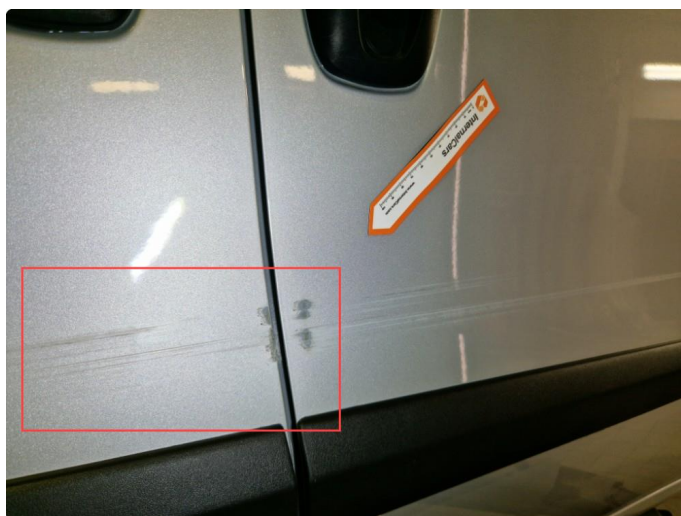
2.2 Lakkskader / riper h-bakdør.
