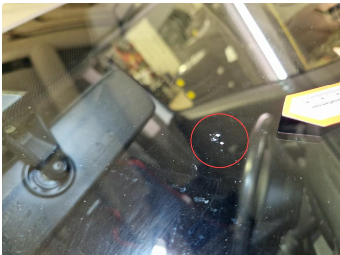
2.15 Noe steinsprut frontrute.
