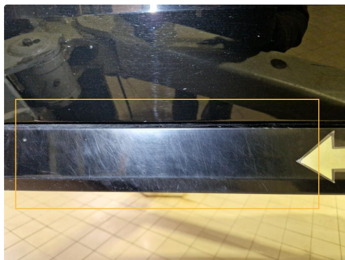
1.6 Riper kanalskjørt h+v side.
