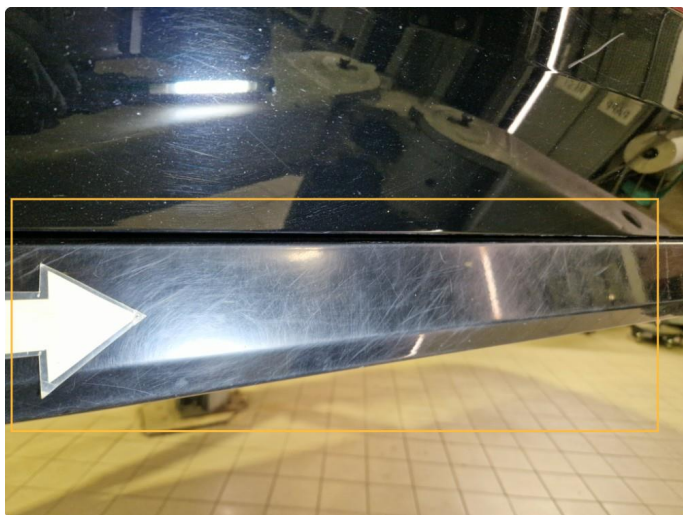
1.6 Riper kanalskjørt h+v side.
