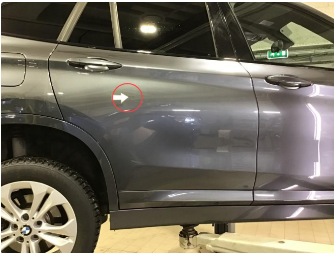
1.2 Liten p-bulk h-bakdør, regnes som normal bruksslitasje.
