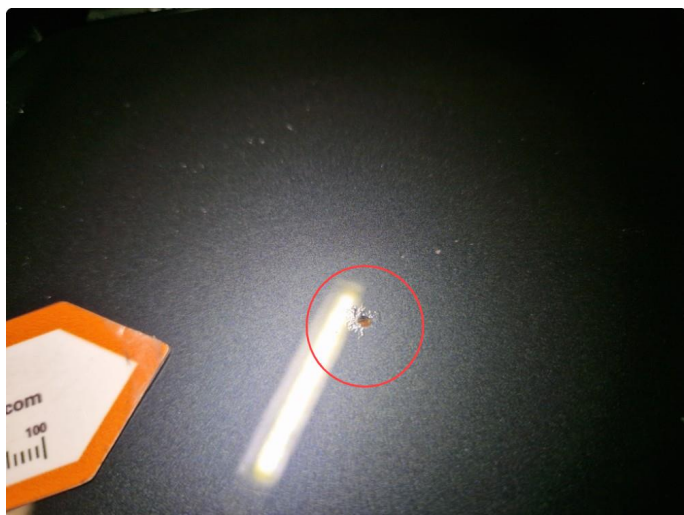
1.4 Steinsprut med rustdannelse v-framskjerm, normal bruksslitasje.
