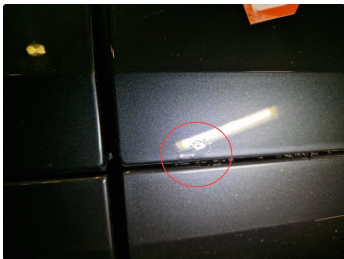
1.3 Flere små rustbobler + p-bulk h 2 -framdør, normalt iht. km og alder.
