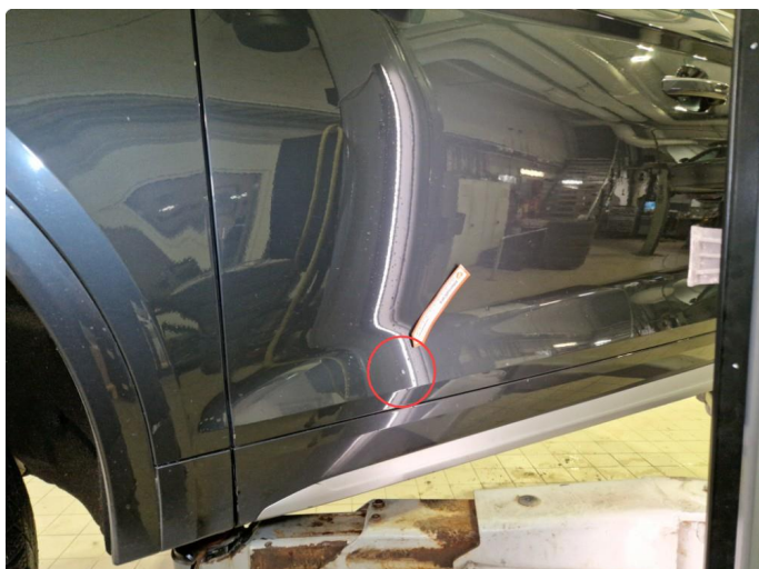
1.1 Flere små rustbobler v-framdør, normalt iht. km og alder.
