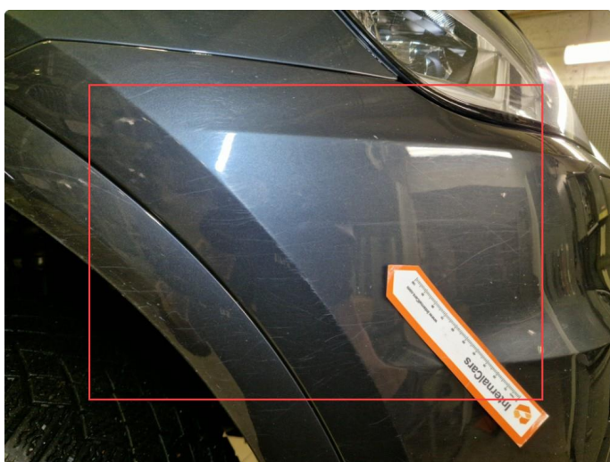
1.11 Noe riper / sår / bruksmerker h-side frontfanger, normal bruksslitasje.
