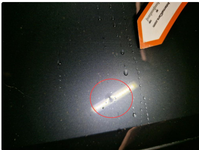
1.1 Flere små rustbobler v-framtdør, normalt iht. km og alder.
