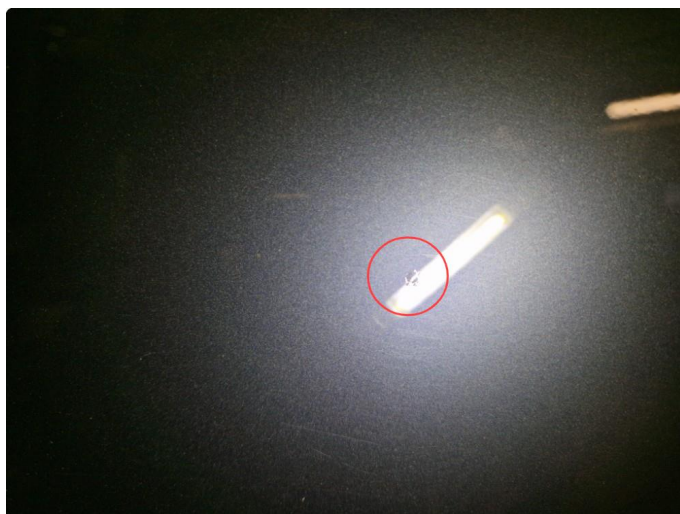
1.2 Flere små rustbobler + p-bulk h-bakdoor, normalt iht. km og alder.
