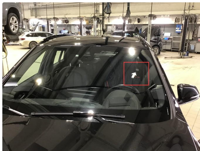
1.5 Steinsprut frontrute, reparert.
