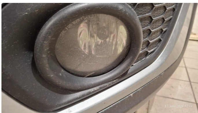
2.2 Tåkelys - defekt / sprukket glass
