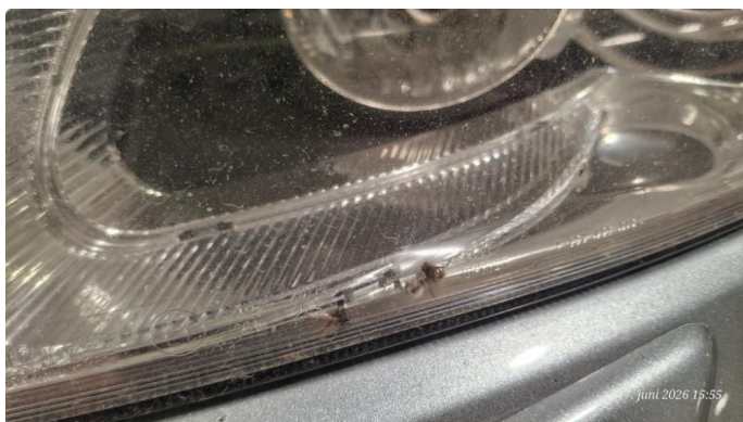
2.3 Lokk på lyshus mangler
