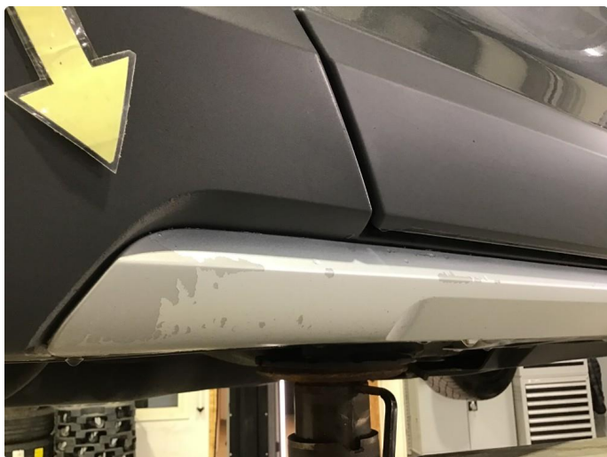
1.6 Lakkflss på kanallist.
