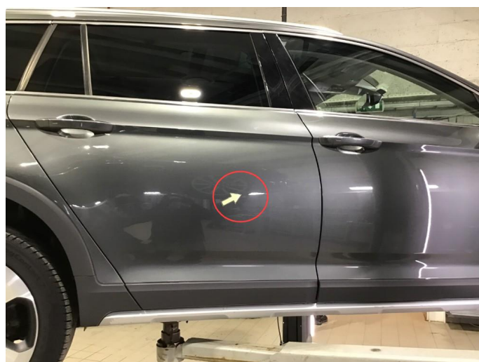
1.2 Liten p-bulk h-bakdør, regnes som normal bruksslitasje.
