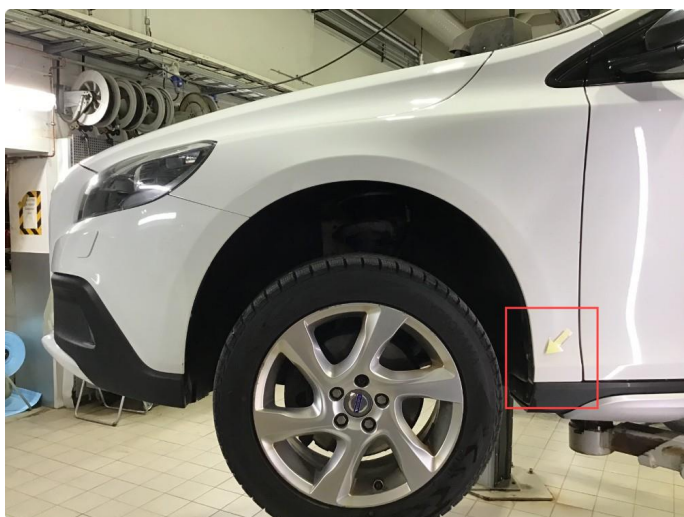
1.3 Zinkblemme/rust nedre del v-fremmskjerm.
