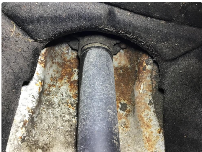
1.2 Noe rust underside + fjærtårn begge sider fremme.
