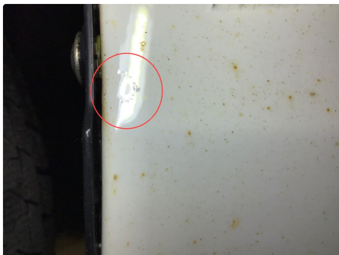
1.3 Zinkblemme/rust nedre del v-fremskjem.
