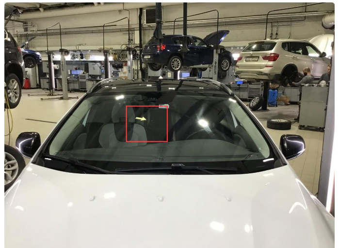
1.10 Noen steinsprut på frontrute, for små til å repareres.
