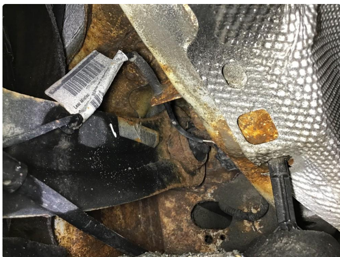
1.2 Noe rust underside + fjærtårn begge sider fremme.
