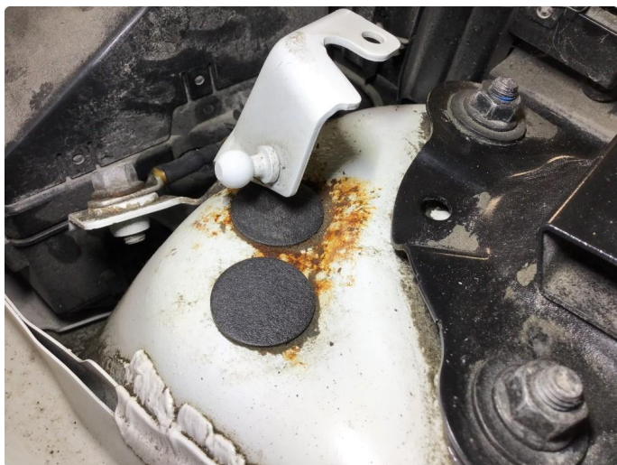
1.2 Noe rust underside + fjærtårn begge sider fremme.
