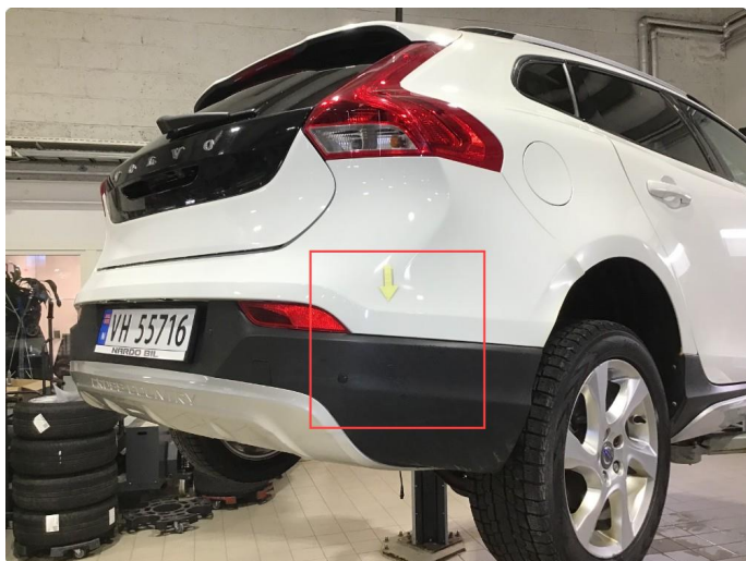
1.9 Liten skade på bakfanger, h-bak.
