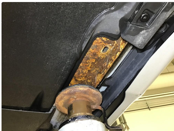
1.2 Noe rust underside + fjærtårn begge sider fremme.
