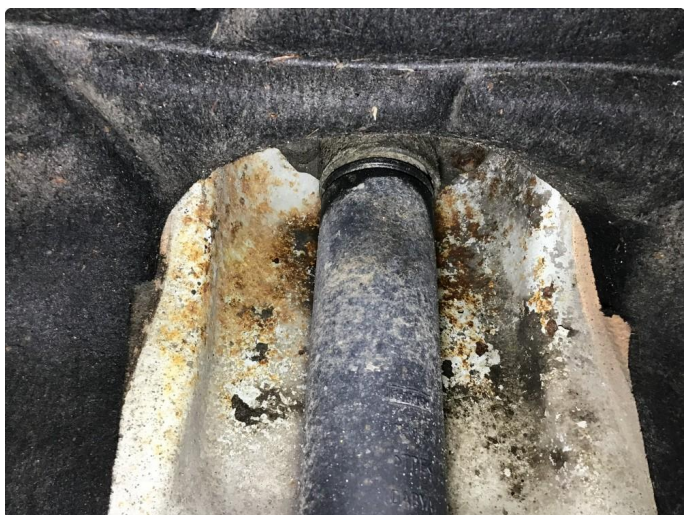
1.2 Noe rust underside + fjærtårn begge sider fremme.
