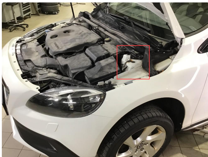
1.2 Noe rust underside + fjærtårn begge sider fremme.
