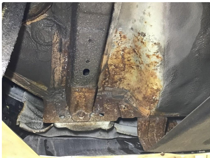
1.2 Noe rust underside + fjærtårn begge sider fremme.
