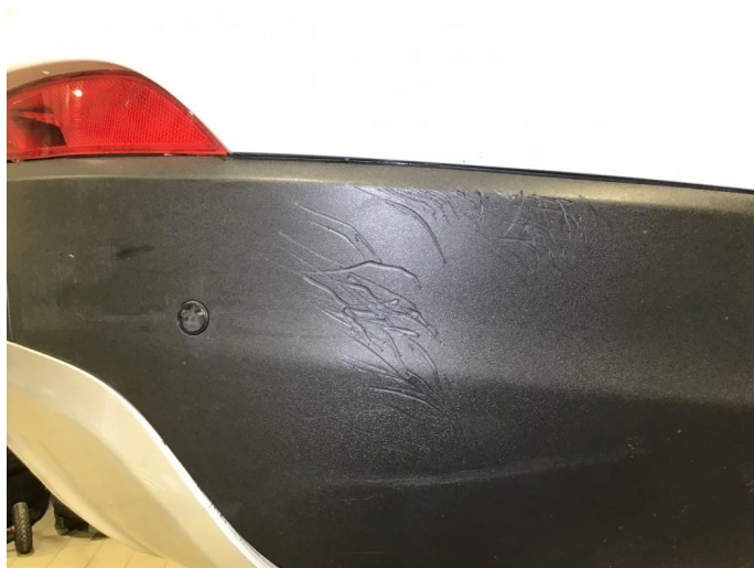
1.9 Liten skade på bakfanger, h-bak.
