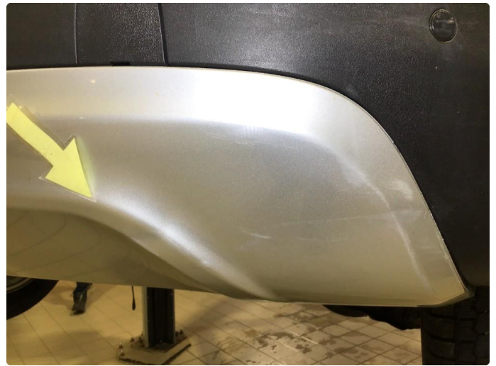
1.9 Liten skade på bakfanger, h-bak.
