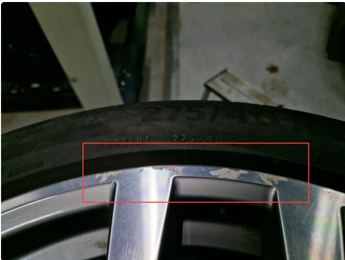
1.3 2 Stk sommerfelger noe sår ( Normal bruksslitasje )
