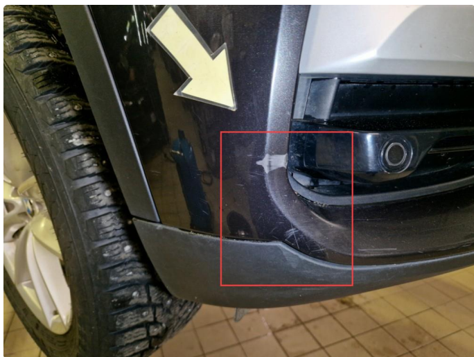
1.7 Noe riper / sår nedre del h-side frontfanger.
