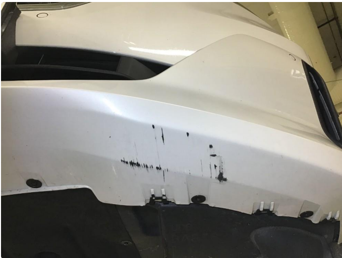
1.3 Noen skrubbermerker underkant fremfanger, regnes som normal bruksslitasje.
