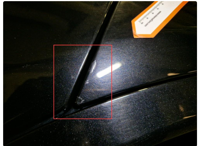
1.3 Noe lakksår v-bakskjerm , er flekket.
