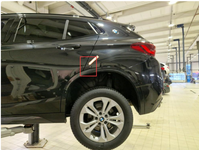
1.3 Noe lakksår v-bakskjerm , er flekket.
