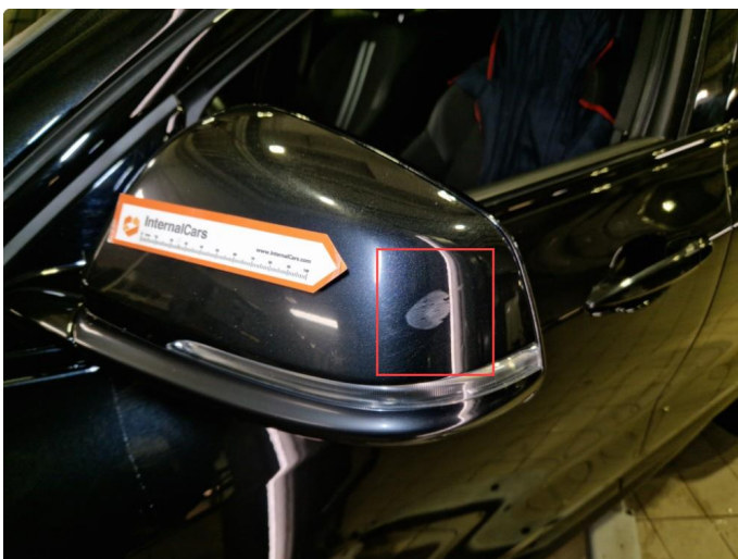
1.4 Noe riper speilkåpe v-side, normal bruksslitasje.
