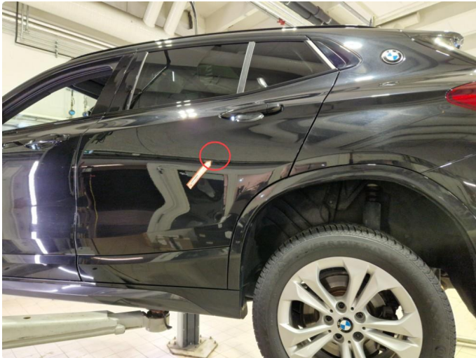
1.1 1 Stk liten p-bulk v-bakdør , normal bruksslitasje.
